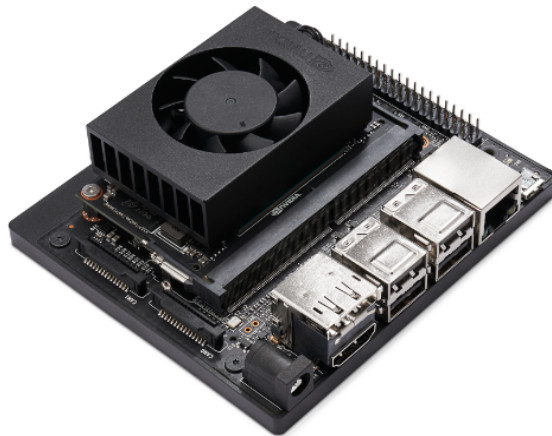
Σχήμα 42: Ενσωματωμένο σύστημα: Jetson Xavier NX. [11]
