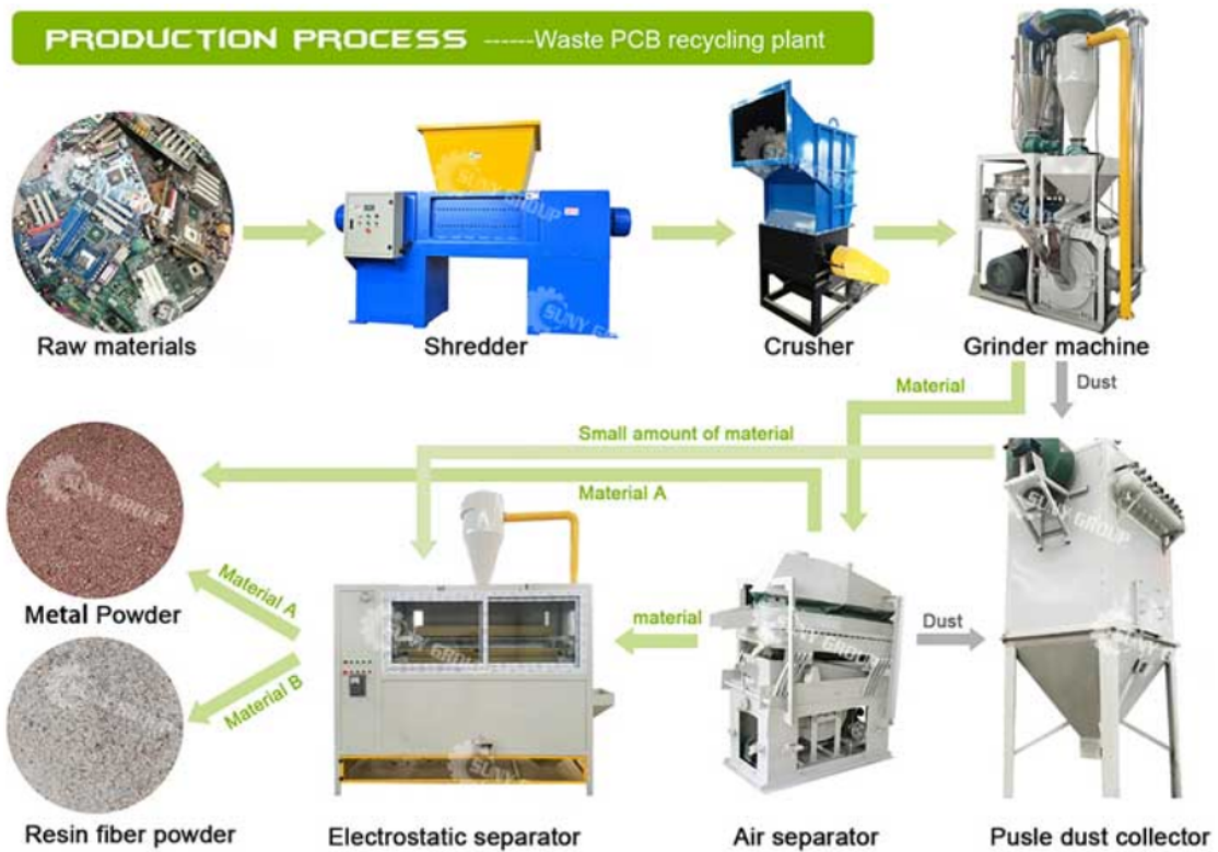
Εικόνα 16: Σχηματική αναπαράσταση διαδικασίας ανακύκλωσης ΑΗΗΕ PCB (Suny Group, 2022)
