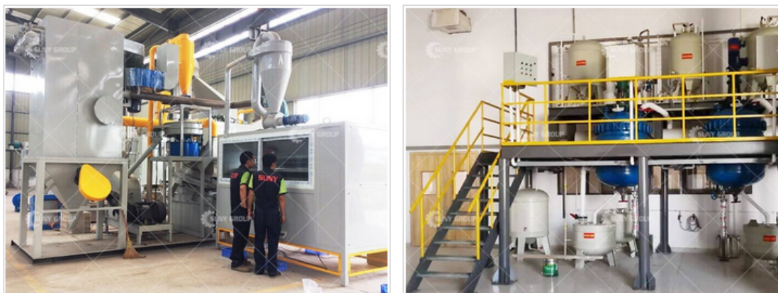
Εικόνα 13: Γραμμή ανακύκλωσης πλακέτας κυκλώματος PCB (αριστερά) Μηχανή εξευγενισμού πολύτιμων μετάλλων (δεξιά) (Sunny Group, 2022)
