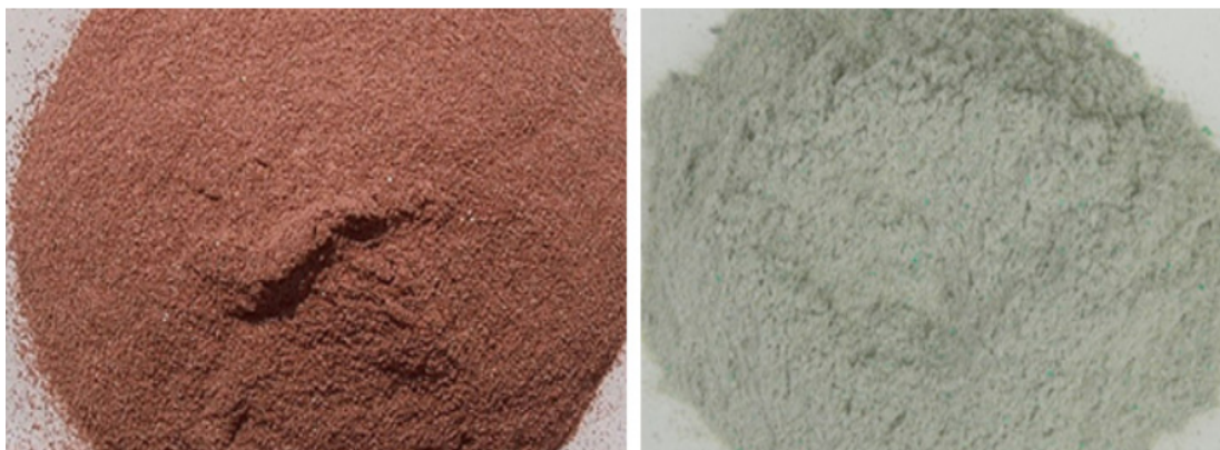
Εικόνα 17: Τελικά αποτελέσματα ανακύκλωσης ΑΗΗΕ PCB: Κλάσματα μεταλλικών υλών (αριστερά) και μη-μεταλλικής σκόνης - ρητίνης (δεξιά) (Suny Group, 2022)
