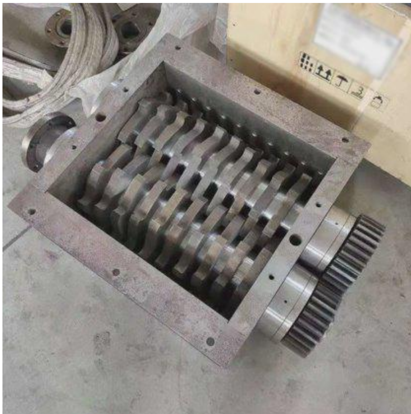
Εικόνα 40: Λεπίδες εργαστηριακού τεμαχιστή μετάλλων. Η πλακέτα διοχετεύεται στην είσοδο και κατευθύνεται βαρυντικά και λόγω της δράσης των λεπίδων σε θάλαμο υπό της συσκευής.
