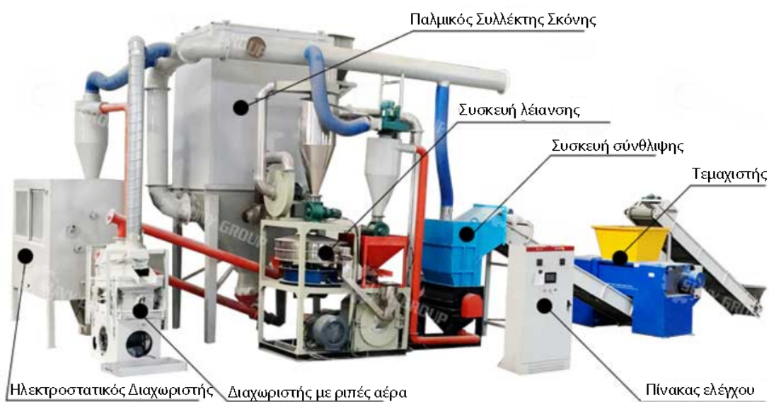
Εικόνα 15: Ολοκληρωμένο σύστημα ανακύκλωσης ΑΗΗΕ - “Εργοστάσιο ανακύκλωσης ηλεκτρονικών απορριμμάτων” (Sunny Group, 2022)
