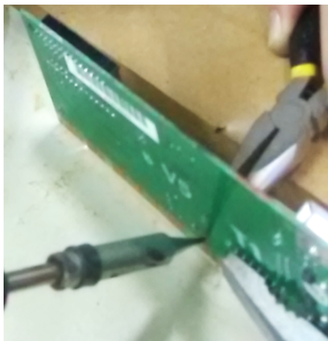
Εικόνα 38: Αποσυναρμολόγηση εξαρτημάτων των “Πράσινης” πλακετών του πειράματος χειρωνακτικά, με χρήση κατα κύριο λόγο εργαλείου κασσιτεροκόλλησης καθώς και dremel. Για μαζική αφαίρεση εξαρτημάτων έγινε χρήση πιστολιού θερμού αέρα.
