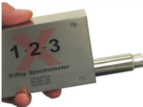
Εικόνες 41: Συσκευή Φασματογραφίας X-123 Amptek detector (αριστερά)
