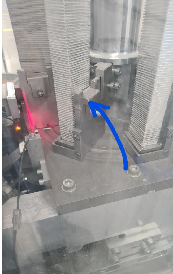
Εικόνα 6.2: Στοιβα πλακών Μονάδα 2-3- σημείο σταματήματος βαριδίου
