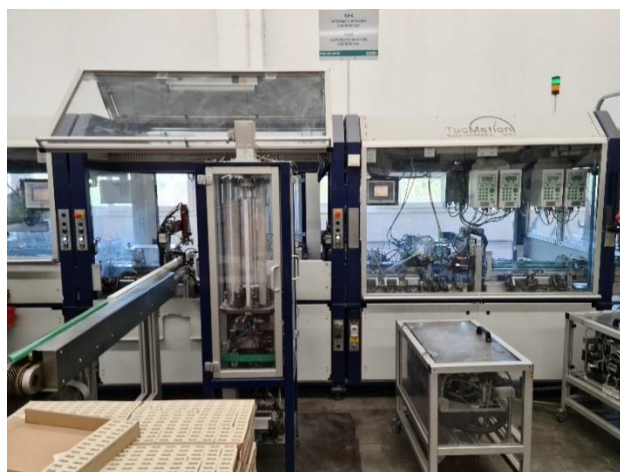
Εικόνα 5: Μονάδα 3- Πέρασμα κεραμικού κορμού στο συγκρότημα αγωγού-επαφών. Τοποθέτηση και βίδωμα πλακών
