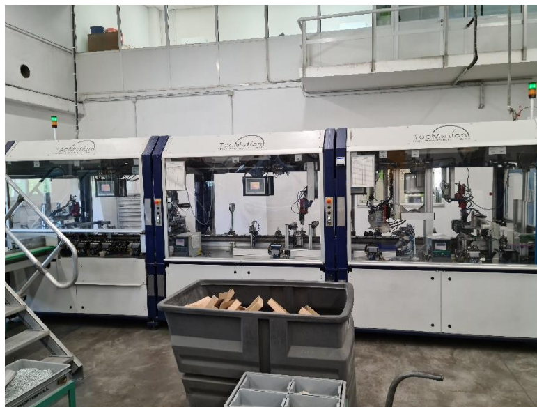
Εικόνα 6: Μονάδα 4- Πέρασμα σύρματος, διαμόρφωση ελάσματος και συγκόλληση ελάσματος-σύρματος
