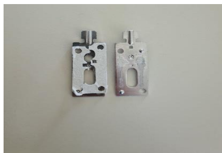
Εικόνα 13: Μη ποιοτικές άνω και κάτω πλάκες
