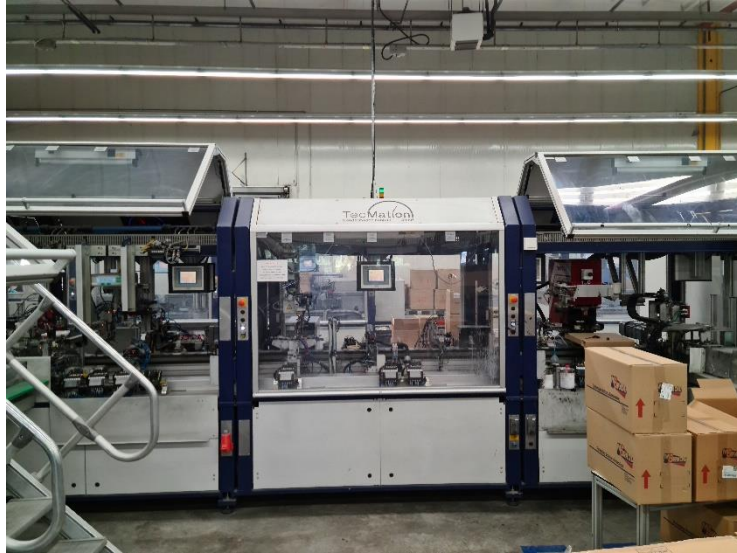
Εικόνα 8: Μονάδα 6- Έλεγχος αντίστασης και εκτύπωση στοιχείων
