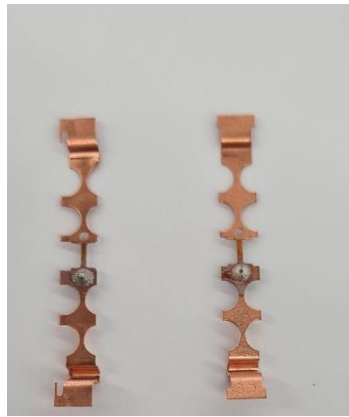
Εικόνα 11: Αποτέλεσμα λάθος θήματος αγωγού (αριστερά λάθος θήμα, δεξιά σωστό θήμα )
