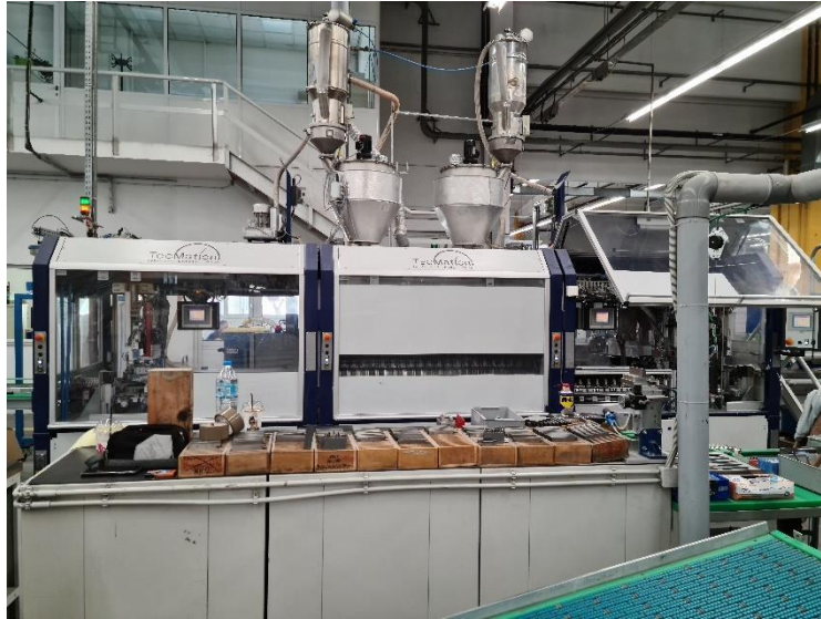
Εικόνα 7: Μονάδα 5- Γέμισμα άμμου και τοποθέτηση τάπας
