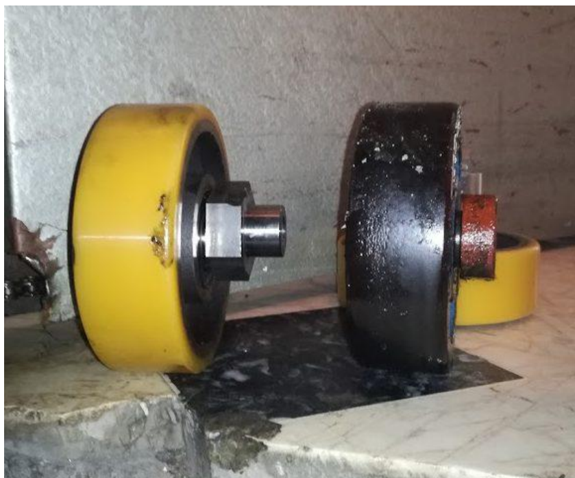
Εικόνα 2. Φθαρμένες ρόδες κυλίσσεως
