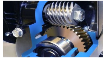
Σχήμα 4.9: Τομή κιβωτίου γραναζιών με χρήση κοχλία [9]
