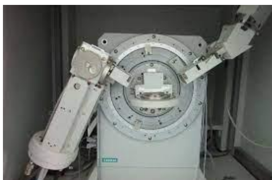
Σχήμα 5-5: Γωνιόμετρο σε κατακόρυφη θέση ( http://eclass.upatras.gr )
