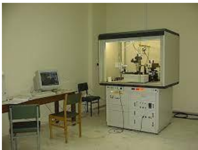
Σχήμα 5-4: Περιθλασίμετρο XRD ( http://old.uoi.gr )
