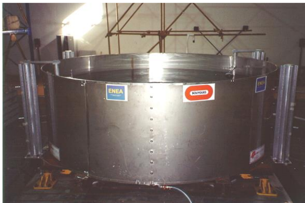
Εικόνα 5.2. Πειραματική διάταξη σεισμικά μονωμένης δεξαμενής υγροποιημένου φυσικού αερίου με πρόσθετη απόσβεση (Castellano et al., 2000).
