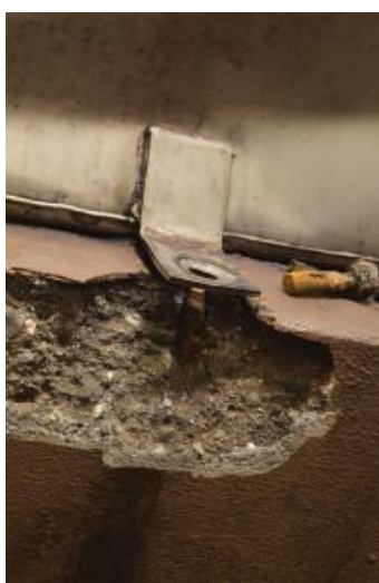
Εικόνα 2.11. Αστοχία του αγκυρίου σε δεξαμενή αποθήκευσης υγρών ( https://www.structuremag.org/?p=8241 ).
