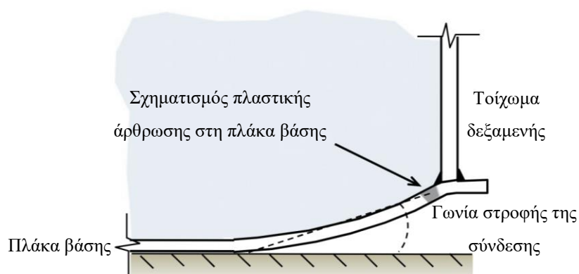
Εικόνα 2.9. Σχηματική απεικόνιση του φαινομένου ανασηκώματος βάσης δεξαμενής (τροποποιημένο από Prinz and Nussbaumer, 2012).
