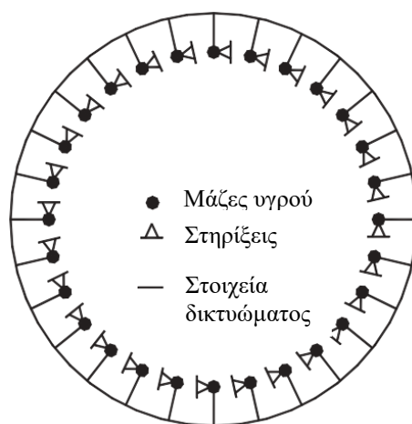
Εικόνα 2.23. Αναπαράσταση προσομοιώματος προστιθέμενων μαζών στην περίμετρο της δεξαμενής (τροποποιημένο από Virella et al., 2005).
