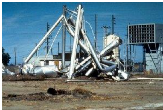
Εικόνα 2.14. Καταστροφή δεξαμενής μετά τον σεισμό Imperial Valley, 1979 ( http://research-it.berkeley.edu/projects/museum-informatics-project ).
