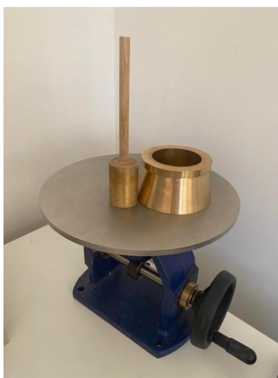
Σχήμα 4.2. Τράπεζα εξάπλωσης (μοντέλο UTCM-0660E) που χρησιμοποιήθηκε για την μέτρηση της εργασιμότητας.
