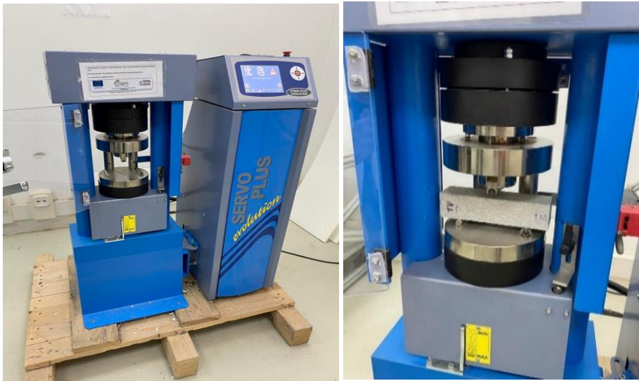
Σχήμα 5.3. (Αριστερά) Μηχανή δοκιμής σε κάμψη-θλίψη διπλής κλίμακας τύπου E161-03N (Servo-plus evolution 500/15 kN) της Matest. (Δεξιά) Κελί φόρτισης για δοκιμή σε κάμψη πρισματικών δοκιμίων 40x40x160mm. ( www.matest.com )
