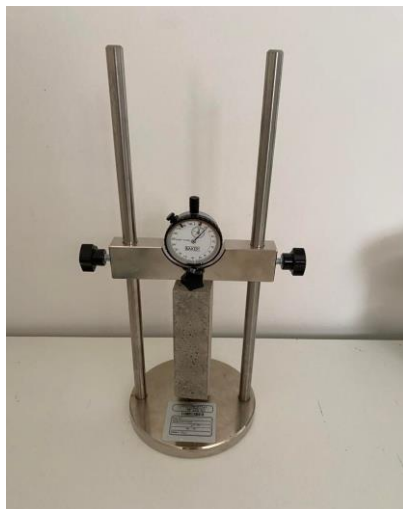
Σχήμα 5.1. Συσκευή μέτρησης της συρρίκνωσης Matest E077.
