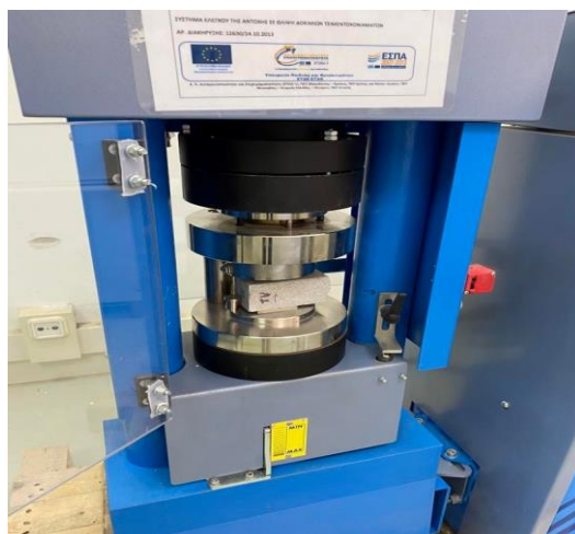
Σχήμα 5.5. Κελί θλίψης για πρίσματα 40x40x160mm.
