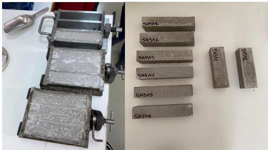
Σχήμα 4.1. Μίγμα κονιάματος σε πρισματικές μήτρες πριν το ξεκαλούπωμα και δείγματα δοκιμίων κονιάματος με 50% αντικατάσταση της λατομικής άμμου.
