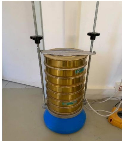
Σχήμα 3.2. Σειρά κόσκινων διαφορετικής διαμέτρου με συσκευή δόνησης.
