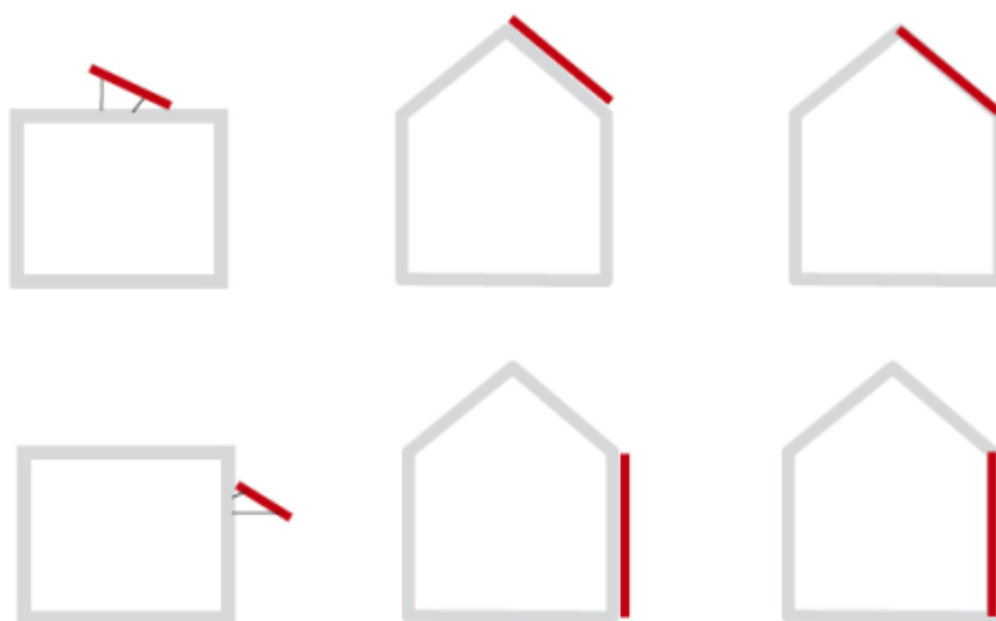
Σχήμα 2.5: Διάφοροι τρόποι εγκατάστασης Φ/Β σε κτήριο [3].
