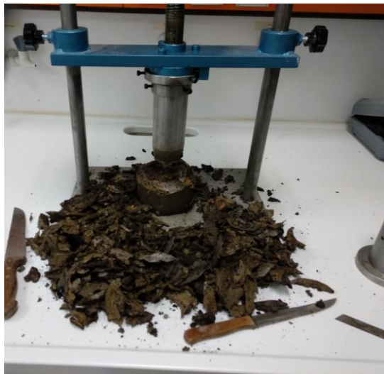
Εικόνα 2.4: Διαμορφωτής δοκιμίων του εργαστηρίου Εφαρμοσμένης Γεωλογίας.
