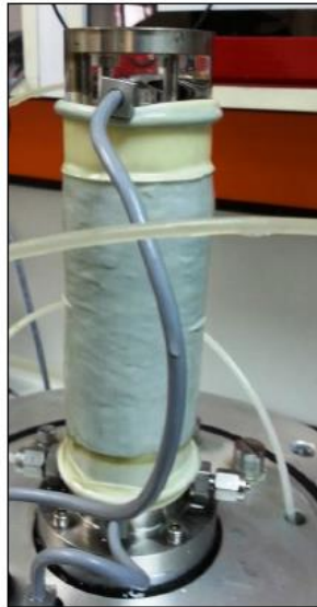
Εικόνα 2.5: Δοκίμιο με που έχει εγκατασταθεί στην βάση έδρασης της τριαξονικής κυψέλης.
