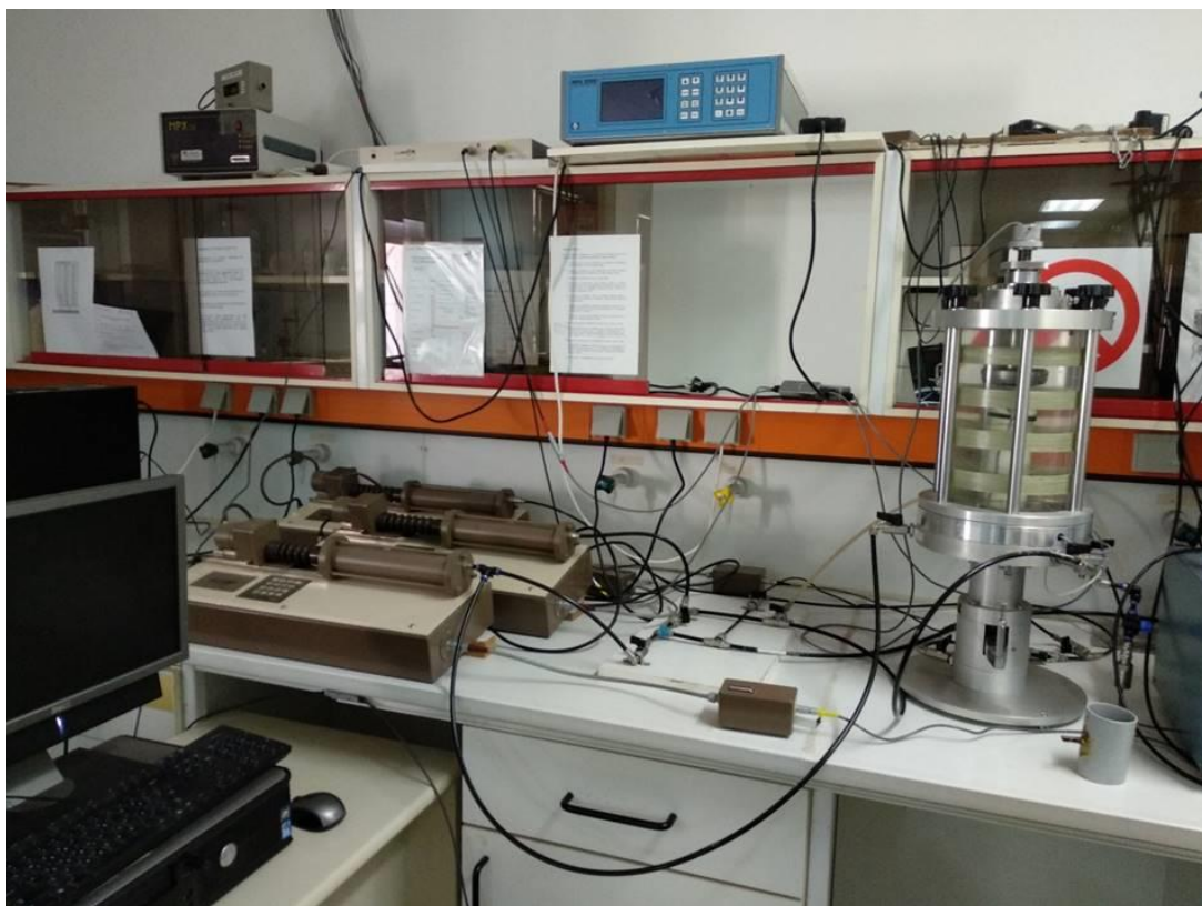
Εικόνα 2.1: Σύστημα τριαξονικής φόρτισης για τη διερεύνηση των παραμέτρων αντοχής.
