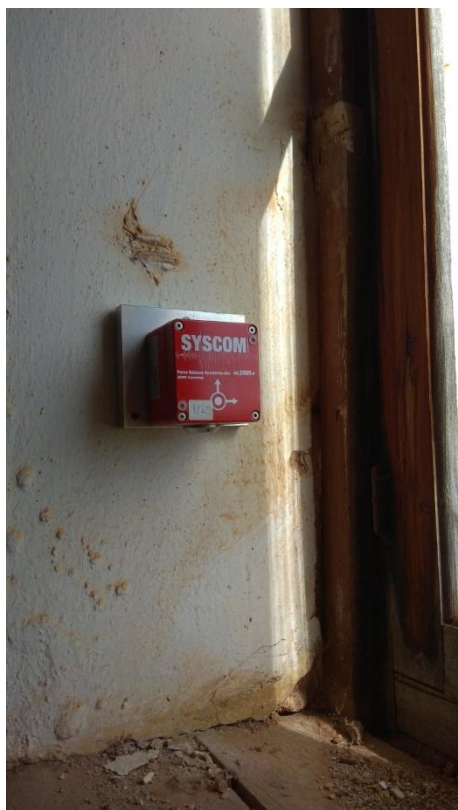
Εικόνα 109: Τοποθέτηση αισθητήρα επιτάχυνσης στην Πρώην Ιερατική Σχολή
