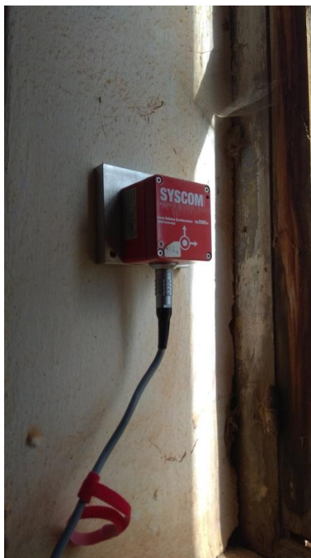
Εικόνα 109: Τοποθέτηση αισθητήρα επιτάχυνσης στην Πρώην Ιερατική Σχολή
