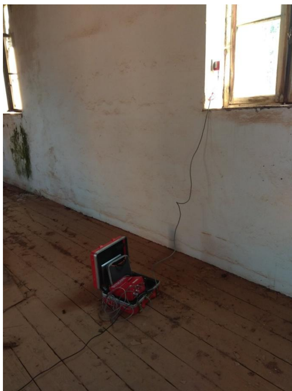
Εικόνα 108: Τοποθέτηση συσκευής επιταχυνσιομέτρων στην Πρώην Ιερατική Σχολή
