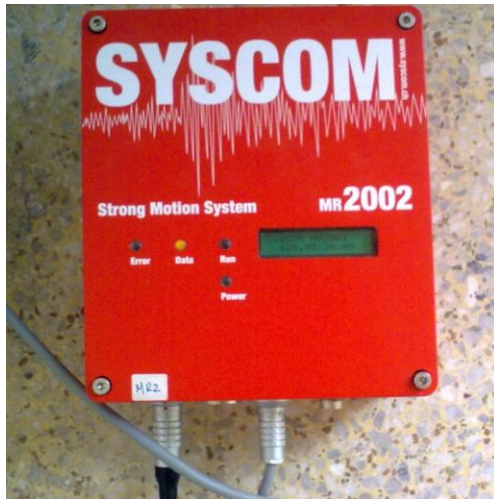
Εικόνα 106: Αριστερά η συσκευής καταγραφικού MR, δεξιά συσκευής συντονισμού «NCC light»
