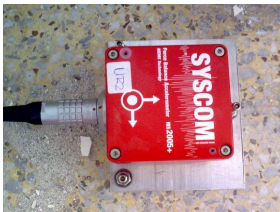
Εικόνα 105: Αισθητήρες επιτάχυνσης MS (επιταχυνσιόμετρα)
