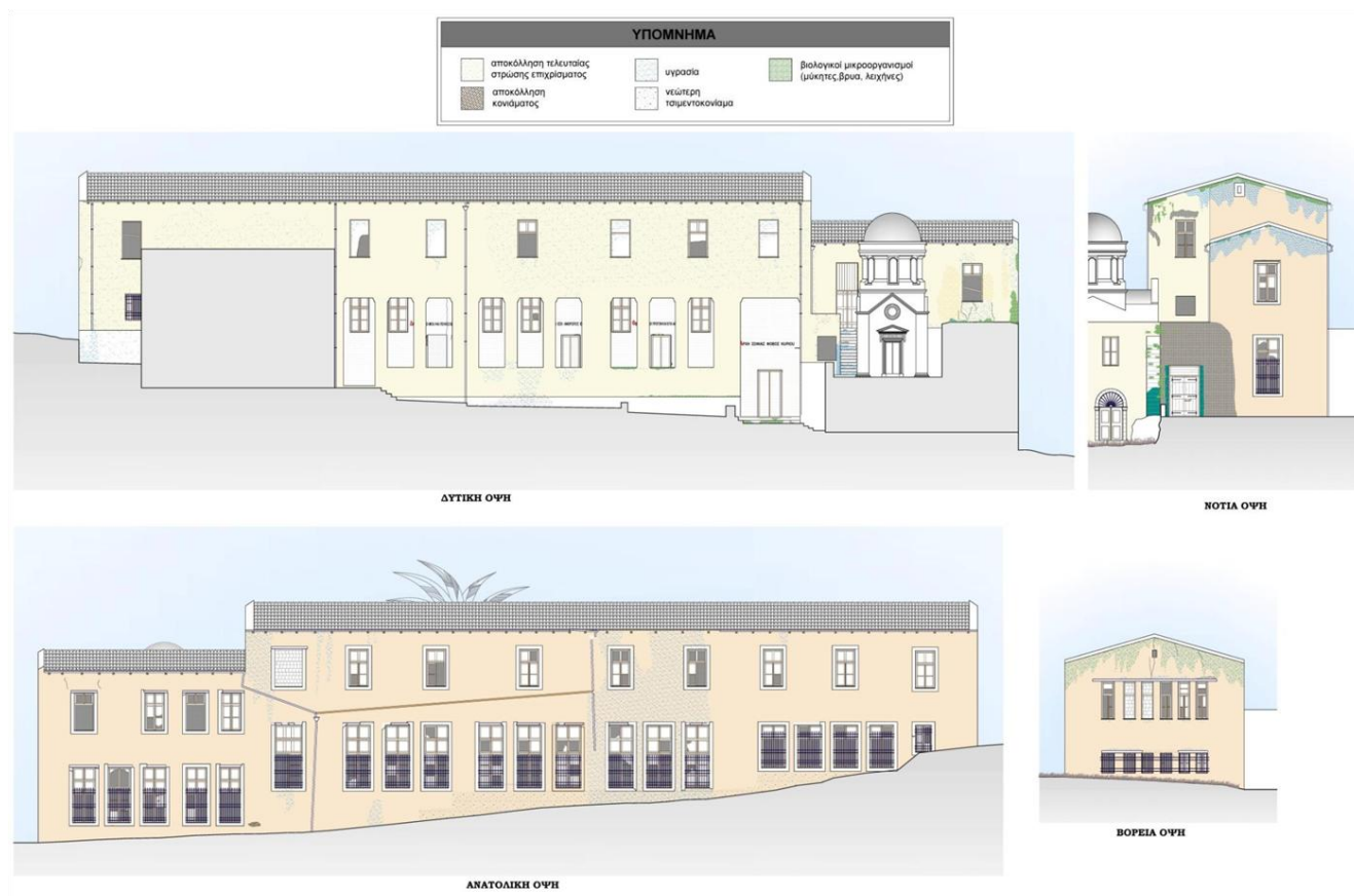
Εικόνα 67 Αποτύπωση φθορών εξωτερικά του κτιρίου [65]
