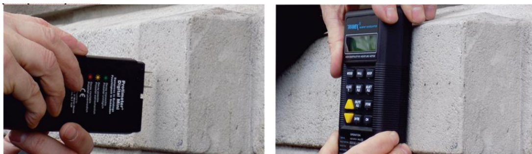
Εικόνα 12: Όργανο μέτρησης της υγρασίας [59]
