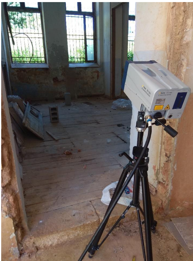
Εικόνα 123: Τοποθέτηση του laser vibrometer εσωτερικά του κτιρίου
