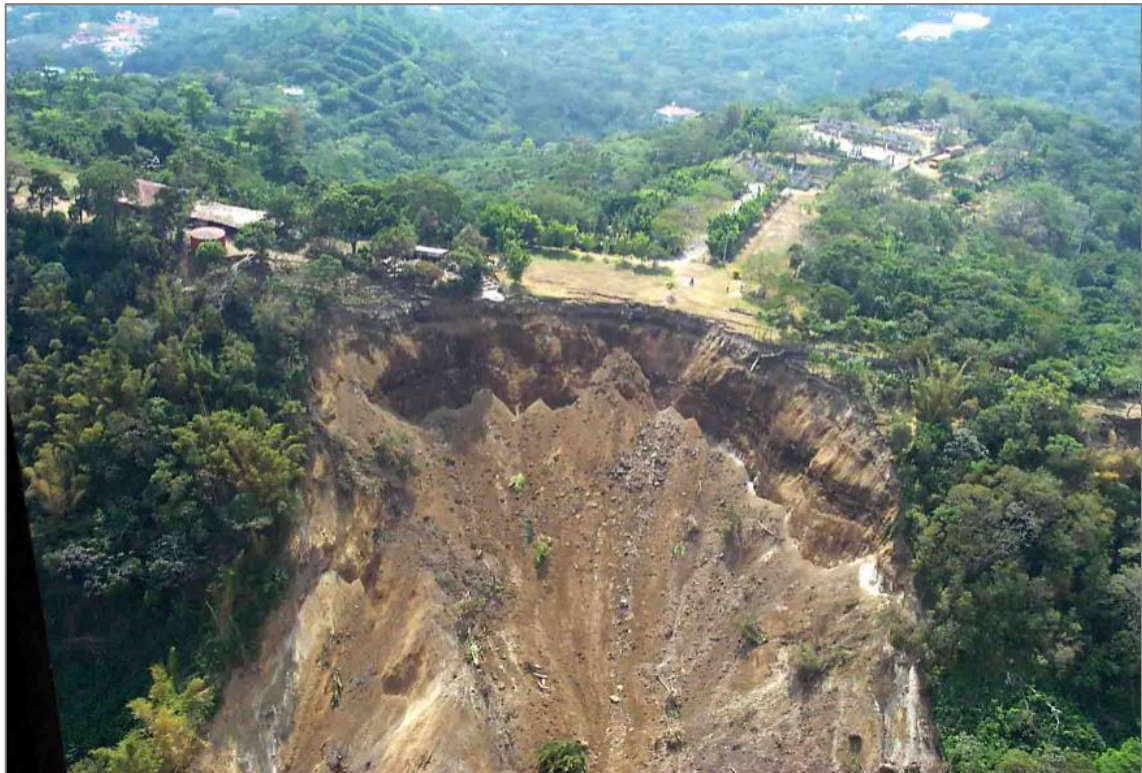
Εικόνα 2.1: Μορφή περιστροφικής αστοχίας βράχου (Μαρίνος, 2011).
