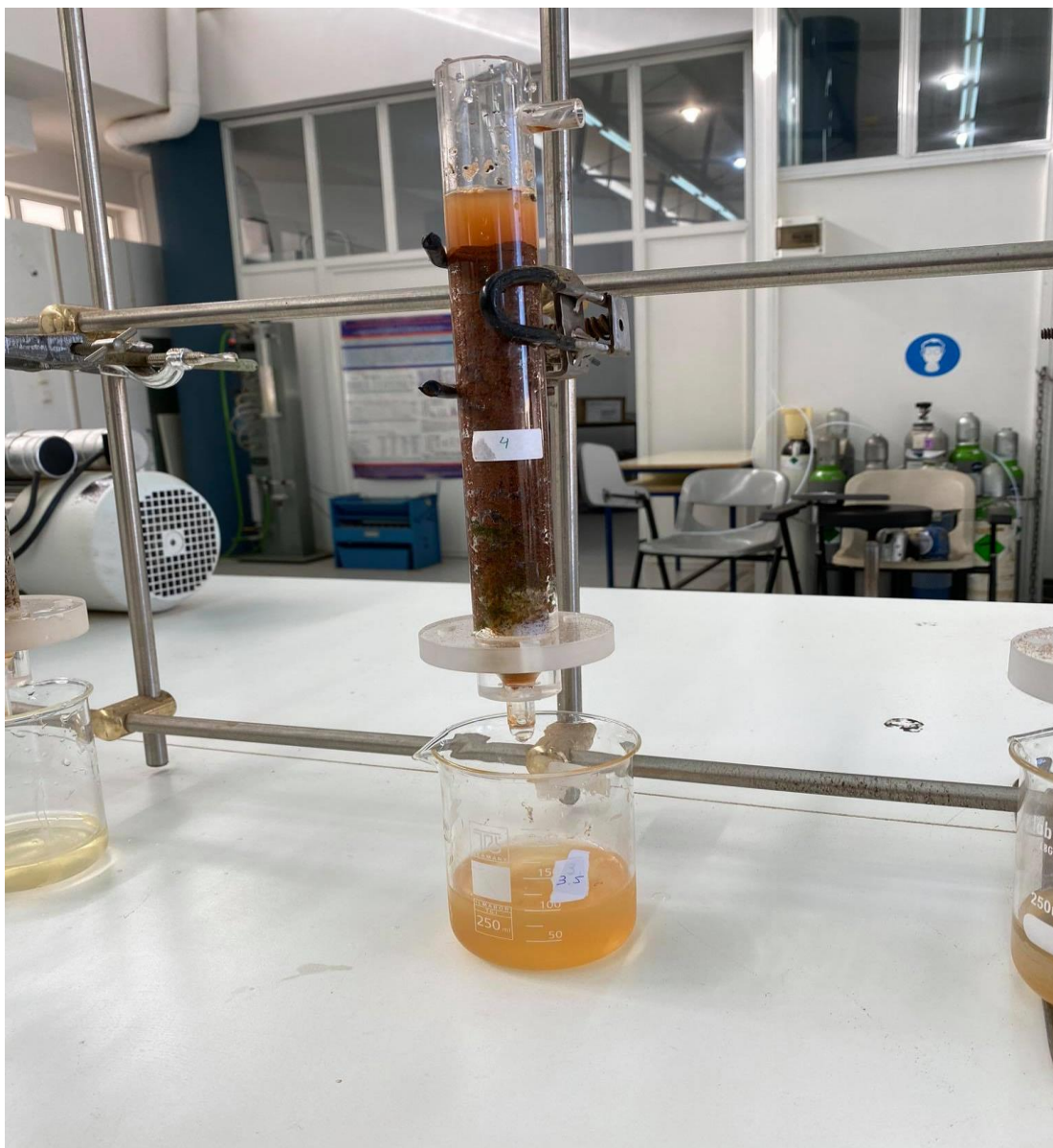
Εικόνα 3.3 Στήλη με ομογενοποιημένα δείγματα και ποτήρι ζέσεως συλλογής εκπλυμάτων.
