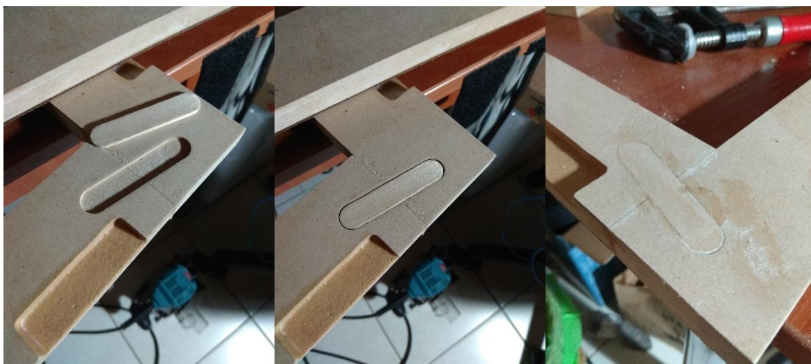
Σχήμα 3.18: Λεπτομέρεια από την σύνδεση του κάτω τελάρου. Εγκατάσταση «μπισκότου». (παρατηρητές μπορεί να προσέξουν ότι τα «μπισκότα» είναι μικρά ξυλάκια για παγωτά).
