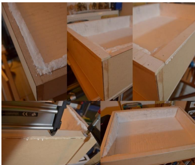
Σχήμα 3.6: Ενίσχυση του χείλους του άνω πλαισίου με σόκορο από κόντρα πλακέ
