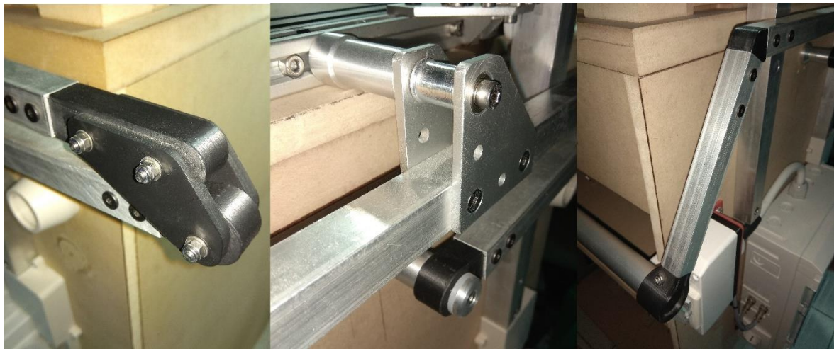
Σχήμα 3.16: Λεπτομέρειες από τα εξαρτήματα των μοχλών. Αριστερά: Πίσω άρθρωση, Κέντρο: Πρόσδεση στον ανυψωτή και κάτω άρθρωση. Δεξιά: Εμπρός σταθεροί σύνδεσμοι
