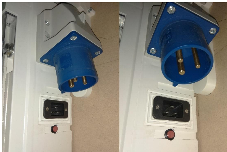
Σχήμα 3.29: Βύσματα παροχής εναλλασσόμενου ρεύματος. Επάνω (μπλέ) 523-6 PCE (32A), κάτω (μαύρο) IEC60320 – C20 (16A). Η διάταξη επιτρέπει μόνο σε ένα βύσμα να είναι συνδεδεμένο κάθε στιγμή.
