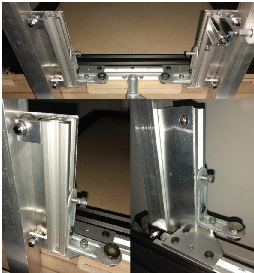
Σχήμα 3.15: Μορφή των ανυψωτών. Κάτω τα κατακόρυφα από την έξω (αριστερά) και έσω (δεξιά) όψη.
