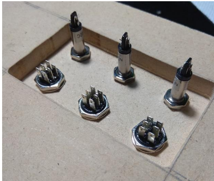
Σχήμα 3.47: Πίσω όψη από την τοποθέτηση των διακοπών και των ενδεικτικών λυχνιών.
