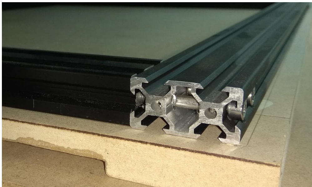
Σχήμα 3.13: Λεπτομέρεια από το άνω τελάρο, όπου φαίνεται ο τρόπος σύνδεσης των προφίλ αλλά και η διατομή αυτών.
