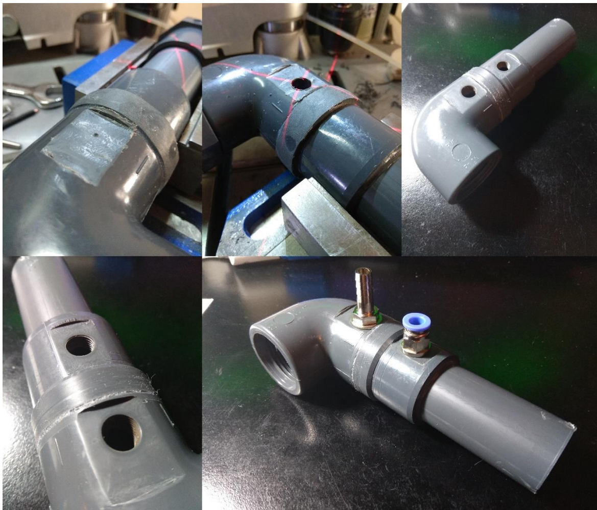
Σχήμα 3.27: Στιγμιότυπα από την κατασκευή του αντάπτορα για την αντλία κενού.
