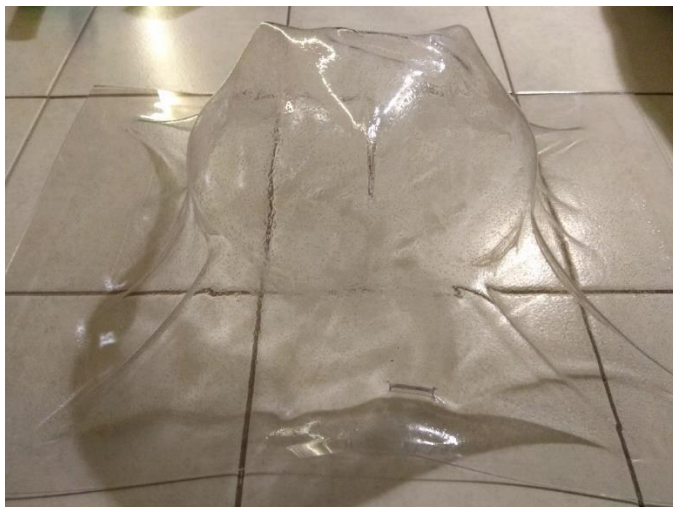
Σχήμα 4.6: Πολυκαρβονικό (PC) 2mm. Αποτυχημένη δοκιμή, έντονη υγρασία, ελλιπής ισχύς θέρμανσης στα 16A.
