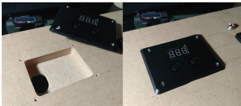
Σχήμα 3.46: Εγκατάσταση του ψηφιακού ποτενσιόμετρου.
