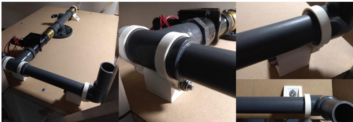
Σχήμα 3.25: Λεπτομέρεια από τον συλλέκτη: Βάσεις στερέωσης πλέον της κύριας φλάτζας.
