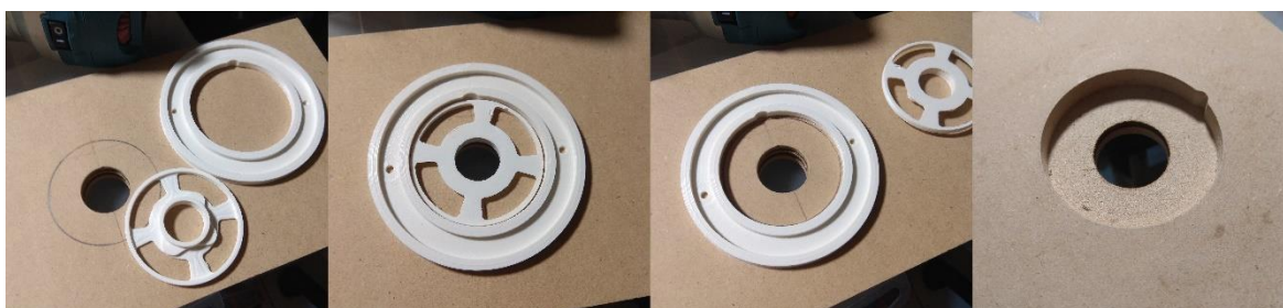
Σχήμα 3.44: Αυτοσχέδιος οδηγός για τον σχηματισμό της φωλιάς του διακόπτη.
