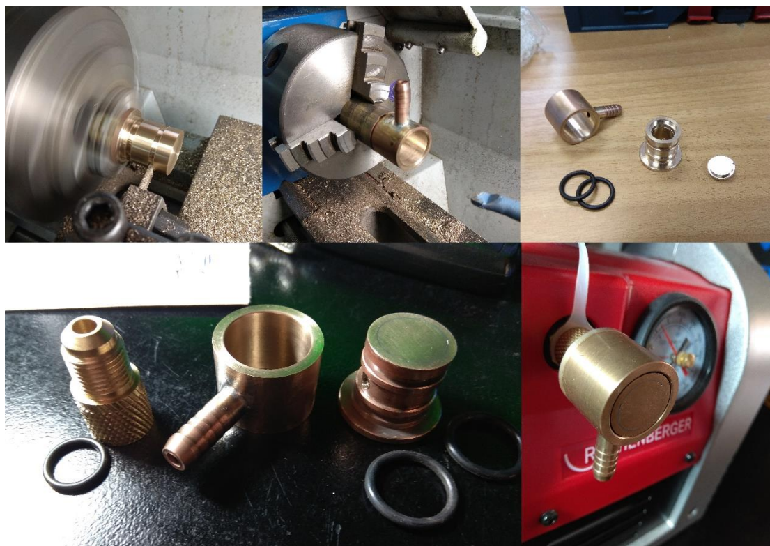
Σχήμα 3.26: Στιγμιότυπα από την κατασκευή του αντάπτορα για την αντλία κενού.
