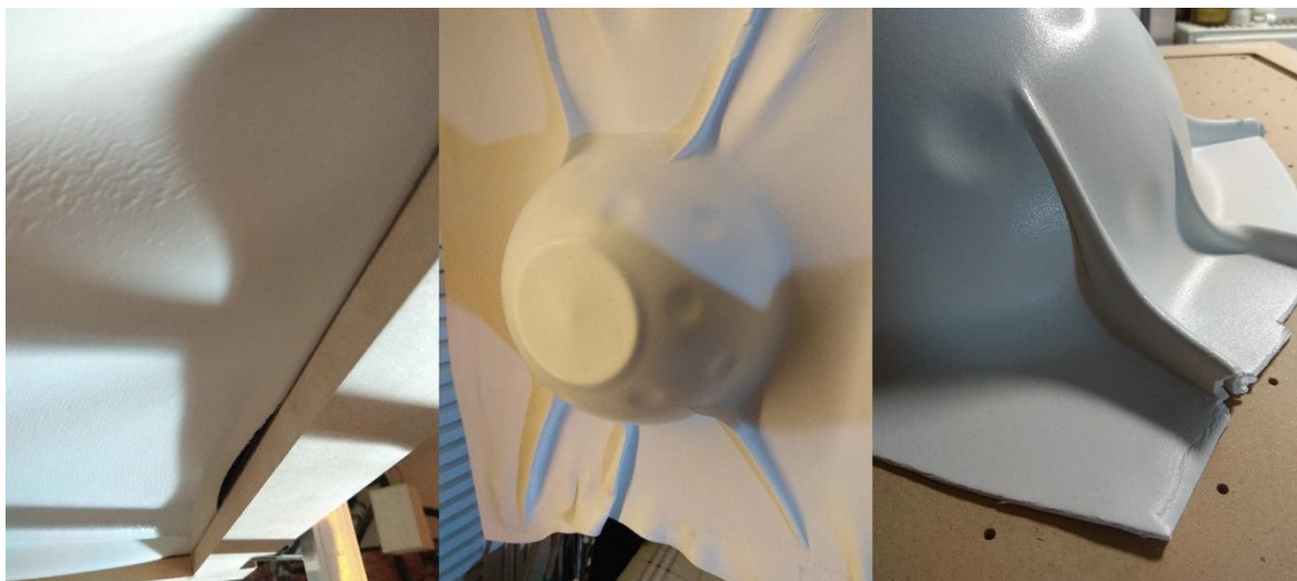
Σχήμα 4.5: Βινύλιο 2.2mm. Αριστερά φαίνεται ότι το υλικό κατάφερε να ελευθερωθεί από το πλαίσιο. Οι έντονες ριγώσεις κάνουν το αντίγραφο μη χρησιμοποιήσιμο.
