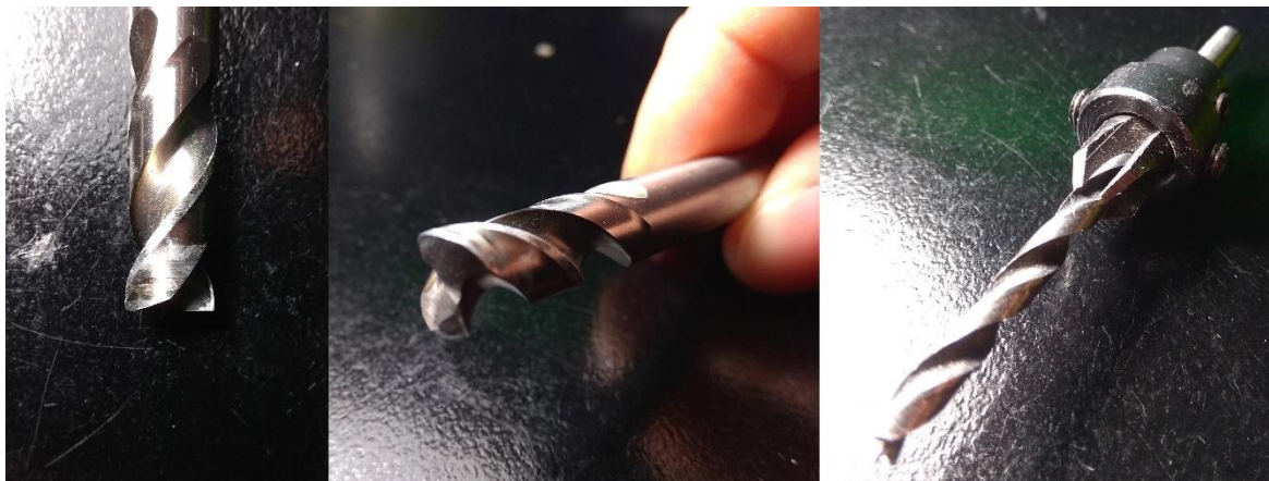
Σχήμα 3.14: Τα δύο εργαλεία που χρησιμοποιήθηκαν για την διάνοιξη των εδρών για τις βίδες. Αριστερά και κέντρο το αυτοσχέδιο κονδύλι, δεξιά το φρεζοτρύπανο
