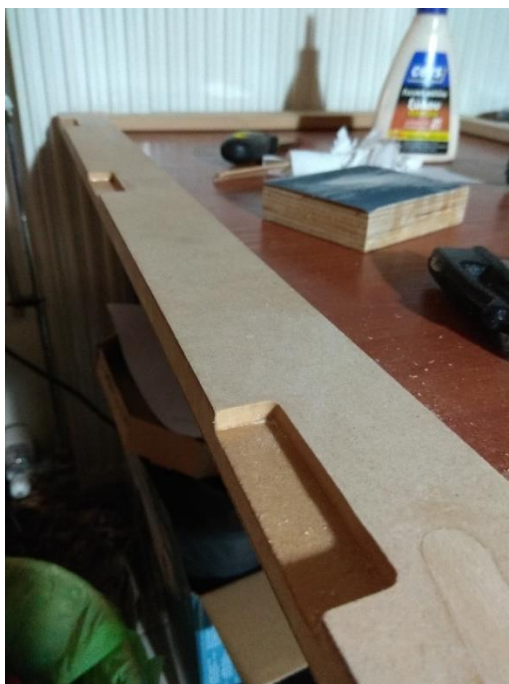
Σχήμα 3.19: Εγκοπές για την εισαγωγή συνδετήρων
