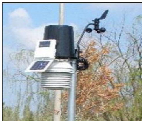
Εικόνα 2.2: Αυτόματος μετεωρολογικός σταθμός (θερμογράφος)
