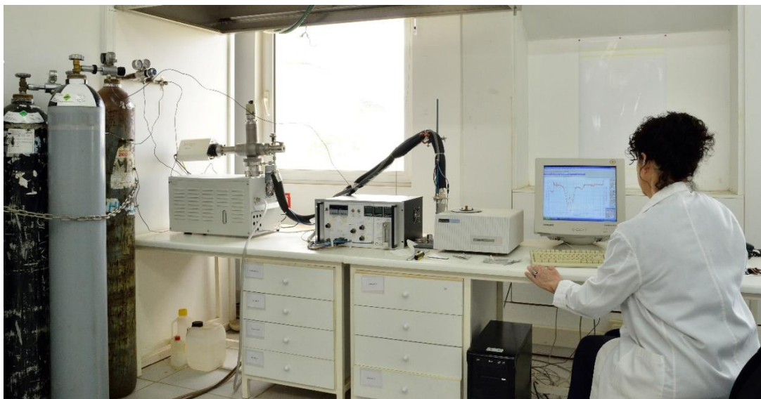
Εικόνα 3.2 Διάταξη θερμοζυγού-φασματογράφου μάζας (TG-MS)
