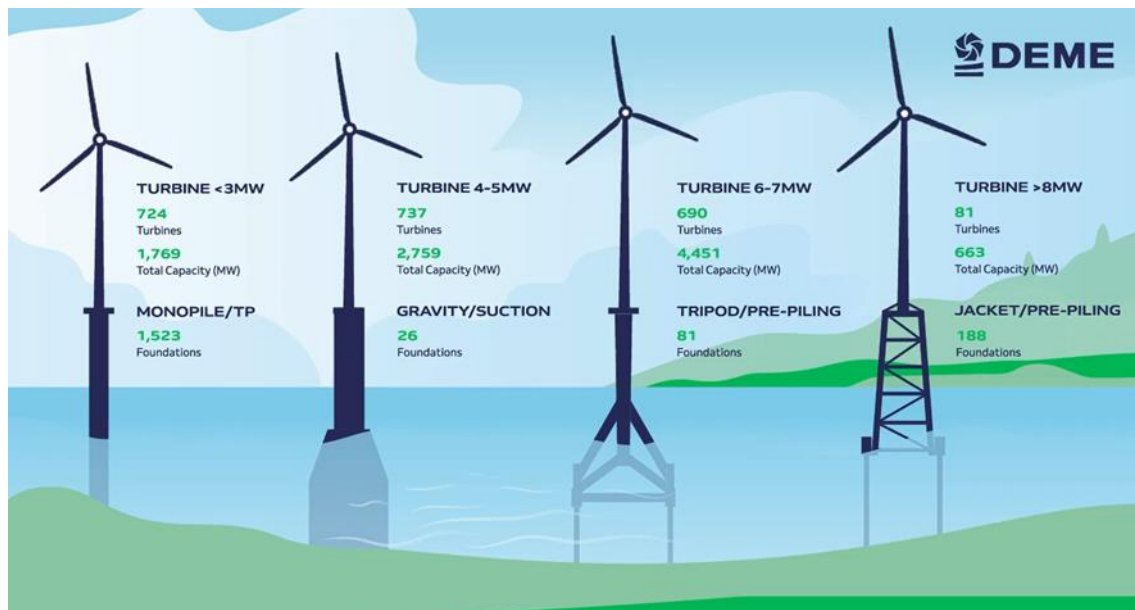
Εικόνα 8, Τύποι θεμελίωσης Α/Γ στη θάλασσα, (Offshore | DEME Group, 2021)
