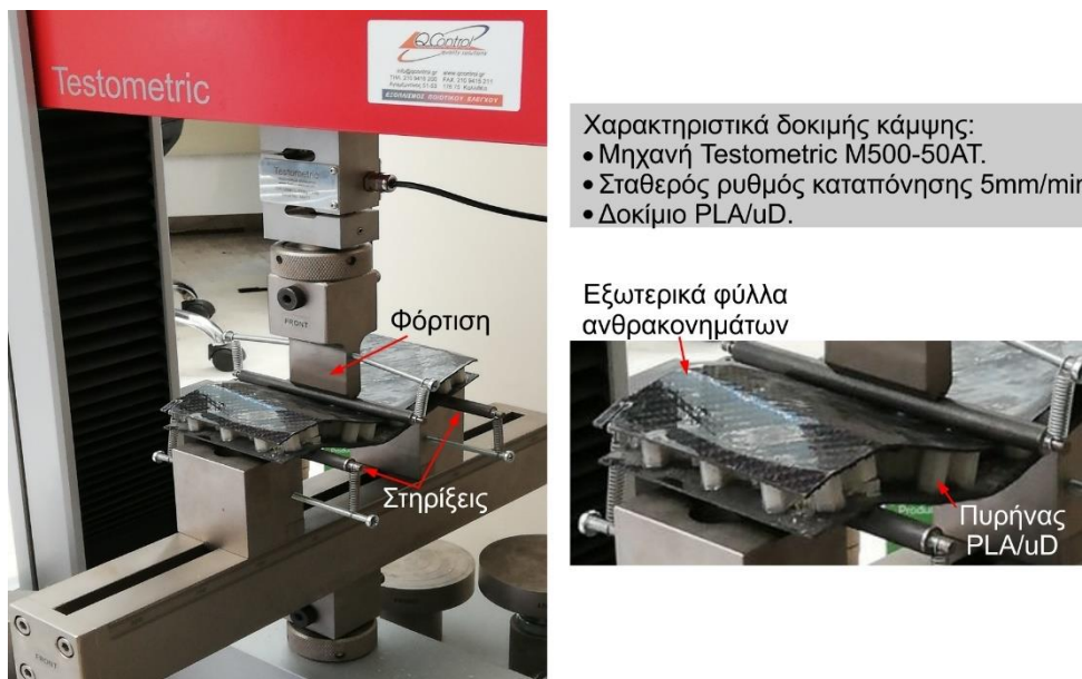
Σχήμα 5.3: Δοκιμή κάμψης τριών σημείων των ιεραρχικών δομών sandwich.
