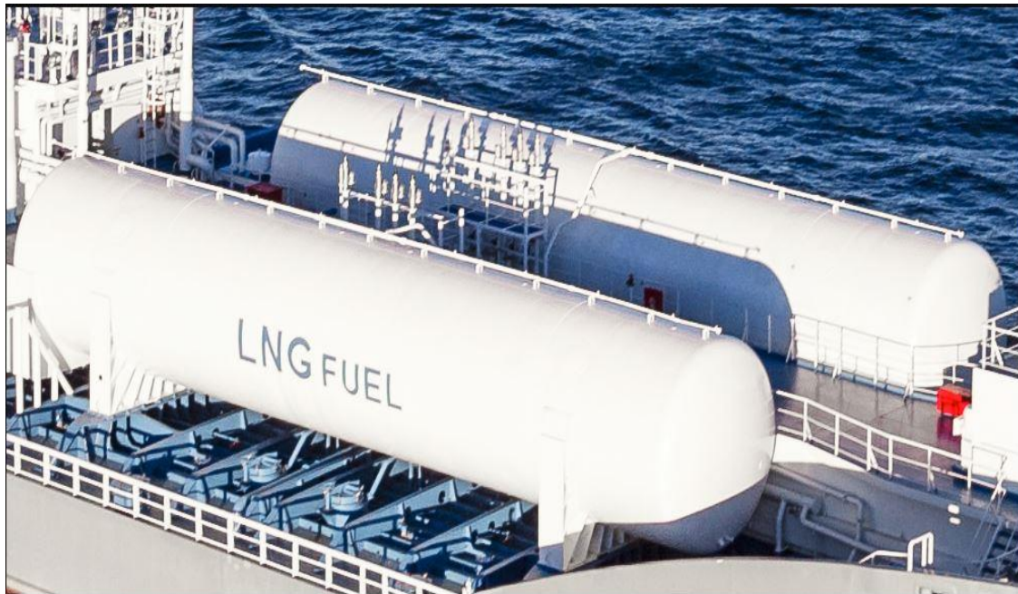
Σχήμα 4.1: Δεξαμενές φυσικού αερίου τύπου C εγκατεστημένες στο κατάστρωμα του πλοίου [73].
