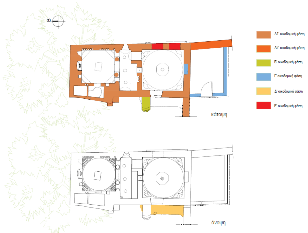
Εικόνα 32: σχέδιο με οικοδομικές – κατασκευαστικές φάσεις χαμάμ σε κάτοψη και άνοψη
