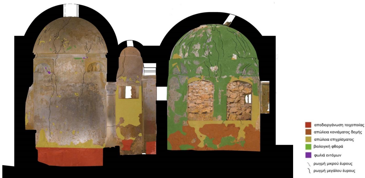
Εικόνα 49: παθολογία σε εκάρσια τομή
