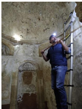
Εικόνα 42: στιγμιότυπο φωτογραφμετρίας στον ψυχρό χώρο πάνω στην σκάλα με υποβοηθούμενο φωτισμό από κάτω και από μπροστά
