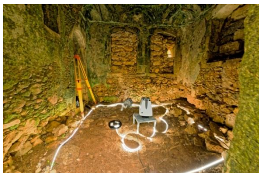
Εικόνα 40: α) αποτύπωση με το laser scanner στον ψυχρό χώρο, β) αποτύπωση με το laser scanner στον ψυχρό χώρο με την χρήση των λεντοταινιών
