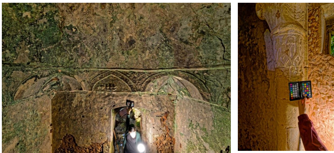
Εικόνα 41: στιγμιότυπα κατά την φωτογραφική αποτύπωση με την φωτεινή πηγή που χρησιμοποιούνταν για τις λήψεις καθώς και την χρωματική παλέτα για την πραγματική απεικόνιση των χρωμάτων
