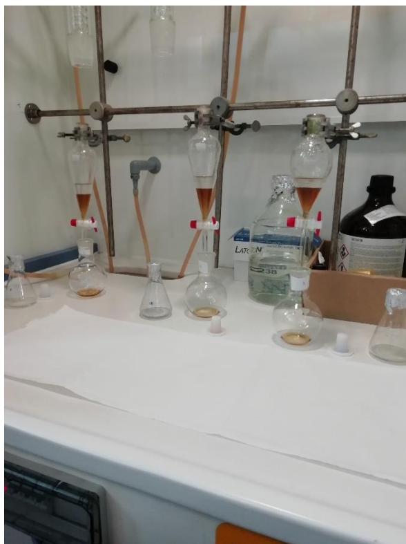
Εικόνα 3.2: Εκχύλιση υδρογονανθράκων. Στήσιμο πειράματος. Εικόνα 3.3: Χοάνη εκχύλισης.
