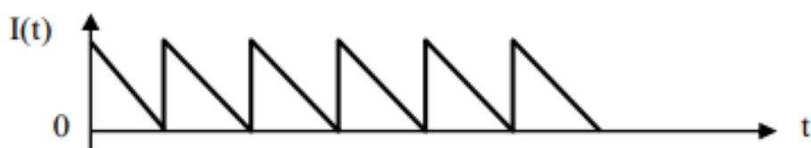
Γράφημα 5: Μοντέλο IV, άπειρος ρυθμός εισόδου με μη επιτρεπόμενη αρνητική στάθμη. Κάθετος άξονας: Ποσότητα παραγγελίας. Οριζόντιος άξονας: Χρόνος. (Πηγή: https://www.eclass.tuc.gr/modules/document/file.php/MPD145/production%20systemsMar2021.pdf )
