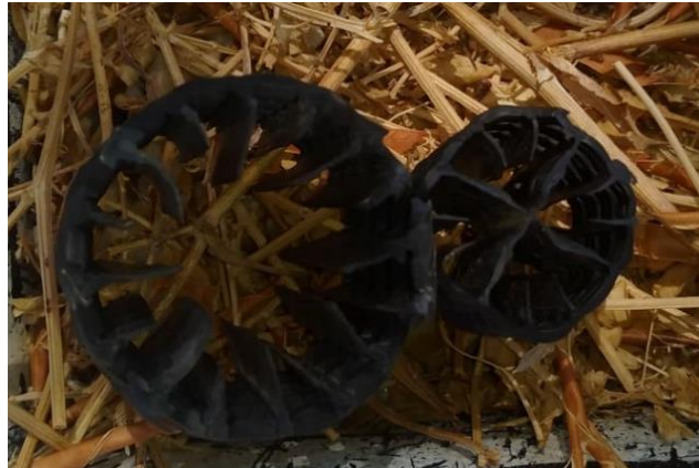
Εικόνα 23: Οι δυο τύποι HDPE που χρησιμοποιήθηκαν ως πληρωτικό υλικό.
