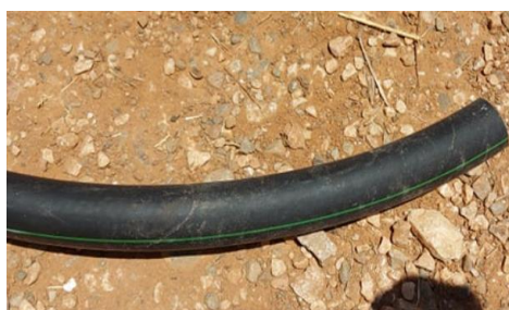
Εικόνα 14: (αριστερά) Εύκαμπτος σωλήνας, (δεξιά) Δύσκαμπτος σωλήνας.
