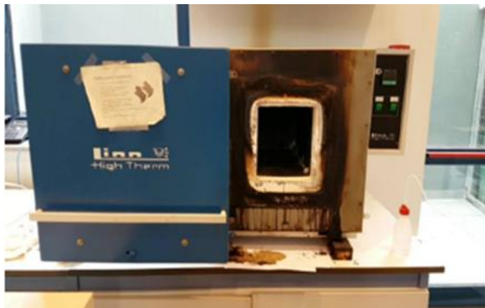
Εικόνα 24: Κλίβανος πυρόλυσης, Linn High Therm.
