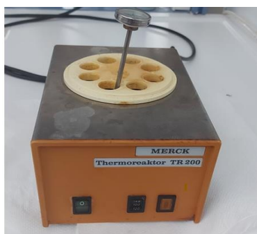
Εικόνα 29: (αριστερά) Θερμοαντιδραστήρας, (δεξιά) Κιτ μέτρησης COD.
