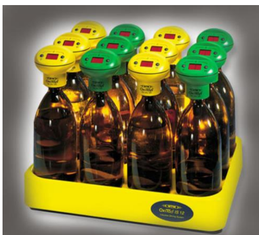
Εικόνα 27 : Φιάλες BOD με μανόμετρα, τοποθετημένες σε σύστημα μαγνητικού αναδευτήρα (Μέτρηση και προσδιορισμός Βιοχημικώς Απαιτούμενου Οξυγόνου, n.d.).
