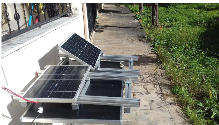
Εικόνα 4.14: Η συστοιχία που χρησιμοποιήθηκε κατά την πειραματική διαδικασία. Αυτή αποτελείται από δύο σε σειρά πάνελ, τα οποία τοποθετούνται σε διαφορετικές κλίσεις προκειμένου να εμφανιστεί το φαινόμενο της σκίασης.
