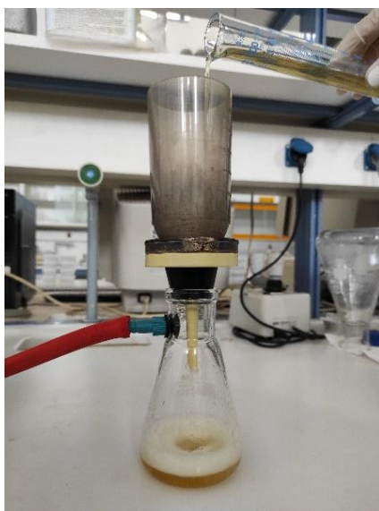
Εικόνα 3.13. Διήθηση, με τη βοήθεια αντλίας κενού, 75ml δείγματος για τον προσδιορισμό των αιωρούμενων στερεών.
