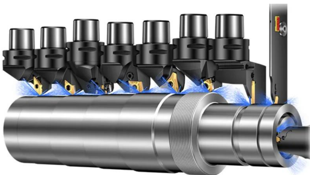
Σχήμα 3.9: Τόρνευση με παροχή ψυκτικού ακριβείας (μέσο του στελέχους) (Πηγή: Sandvik Coromant)
