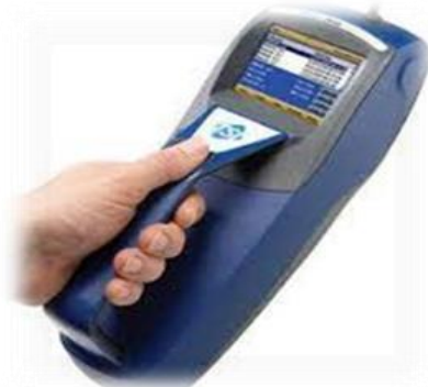
Σχήμα 3.3: Όργανο μέτρησης της συγκέντρωσης της σκόνης τύπου TSI DUST TRACK.
