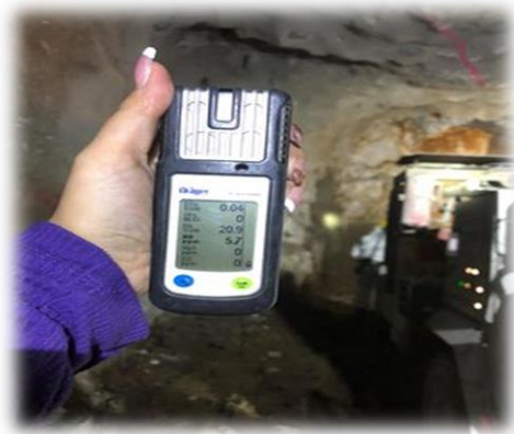
Σχήμα 3.1: Όργανο μέτρησης των αερίων τύπου Dragger x-am 5600.
