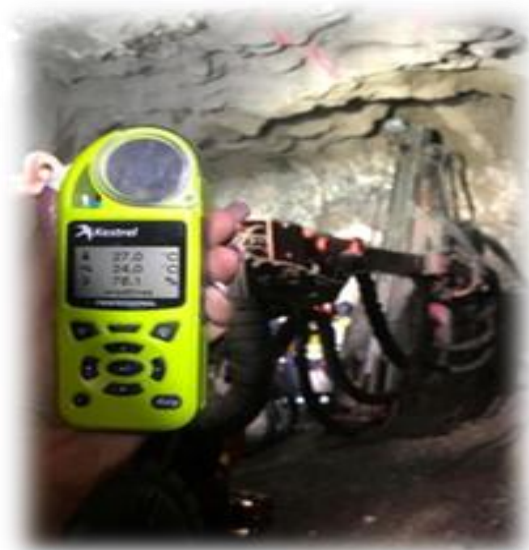
Σχήμα 3.2: Όργανο μέτρησης των μικροκλιματικών παραμέτρων τύπου Kestrel 5700-30.
