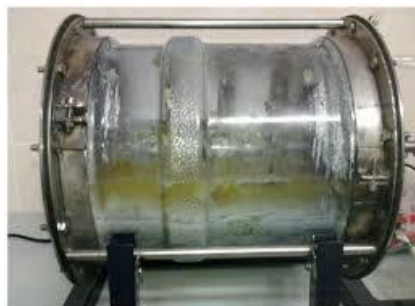
Εικόνα 4: Δεξαμενή ζύμωσης αποβλήτων φαγητού για παραγωγή υδρογόνου
