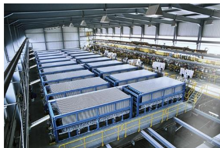
Εικόνα 2: Ηλεκτρόλυση σε βιομηχανική κλίμακα [68]
