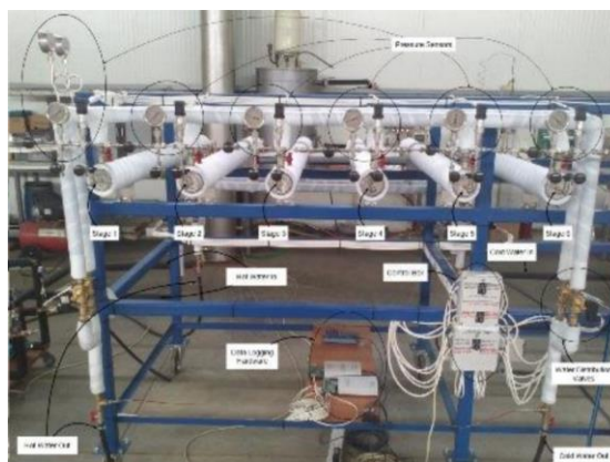
Εικόνα 7: Συμπιεστής μεταλλοϋδριδίων της Cyrus [66]
