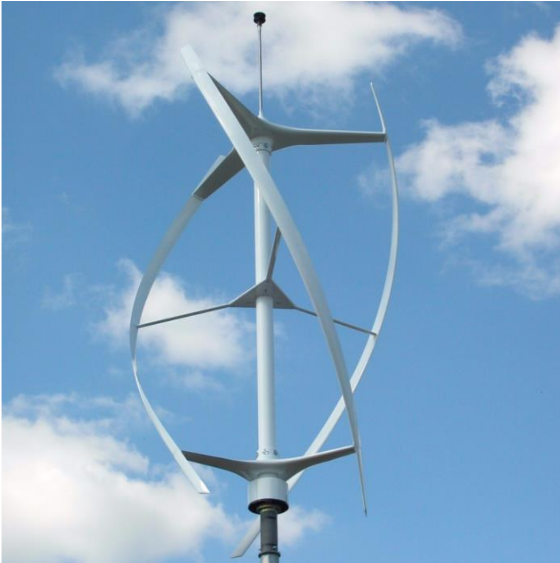
Εικόνα 1.30: Ανεμογεννήτρια κατακόρυφου άξονα ελικοειδούς μορφής, τύπου Helix [Πηγή: https://vwtpower.com/ ].
