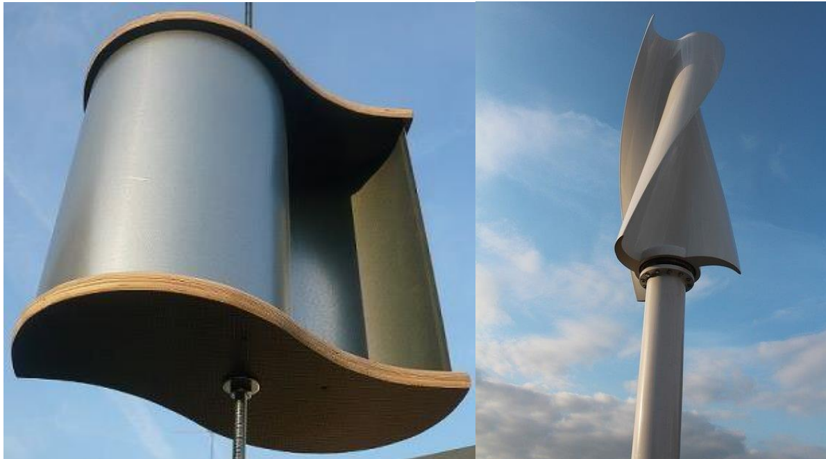
Εικόνα 1.31: Ανεμογεννήτριες κατακόρυφου άξονα τύπου Savonius [Πηγή: pinterest.de , pixabay.com].
