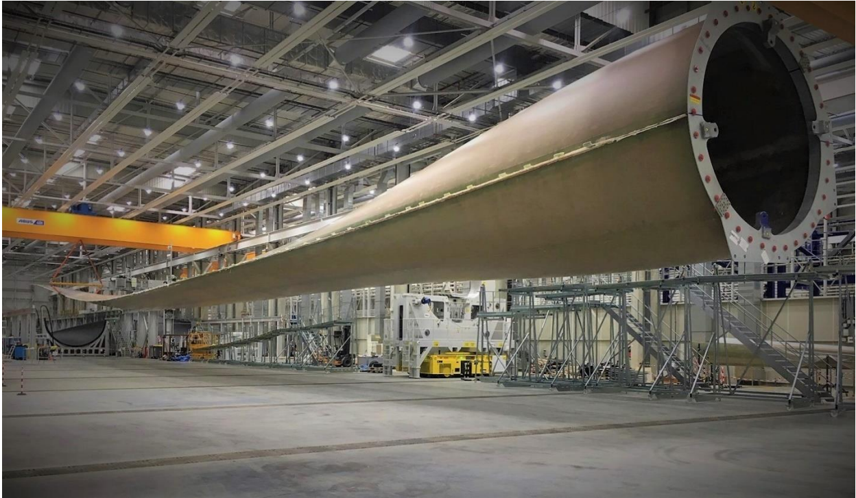
Εικόνα 1.25: Πτερύγιο σύγχρονης ανεμογεννήτριας οριζοντίου άξονα με μήκος 88.4 m [Πηγή: LM Wind Power].
