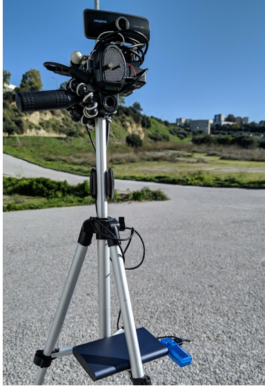
(a) Υπό έλεγχο σύστημα (Node) το οποίο τροφοδοτείται από powerbank κατά την διάρκεια πειραμάτων
