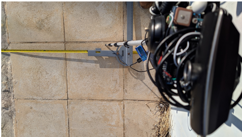
ΕΙΚΟΝΑ 5.5: Υπολογισμός των γωνιών με χρήση εργαλείου μέτρησης γωνίας
