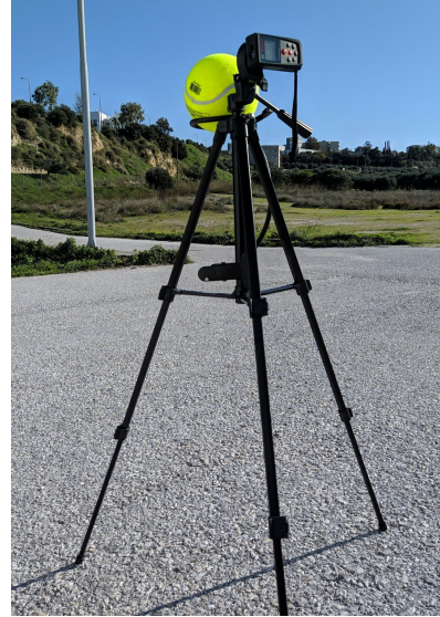
(b) Κινούμενο αντικείμενο εκτίμησης θέσης μαζί με το όργανο μέτρησης απόστασης
