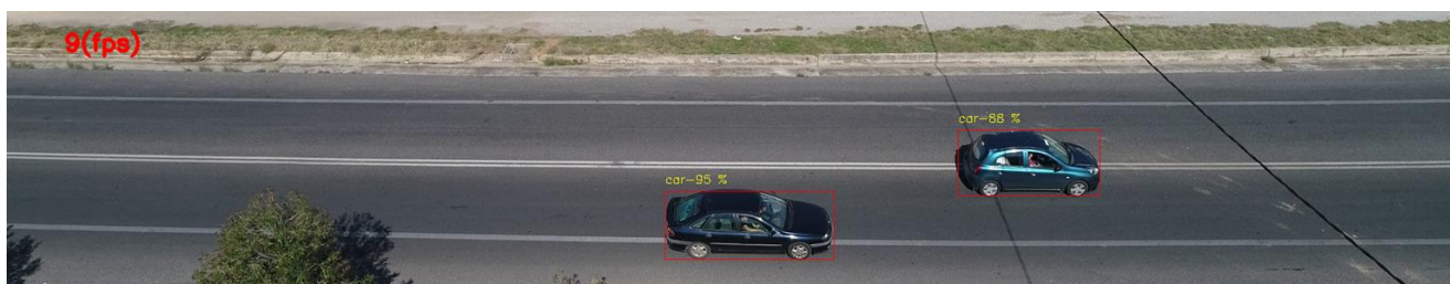
Εικόνα 28: Εφαρμογή αλγορίθμου YOLO με ανάλυση εικόνας 512x512
