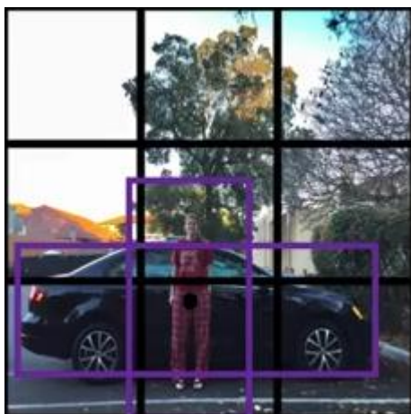
Εικόνα 19: Χρήση anchor boxes
