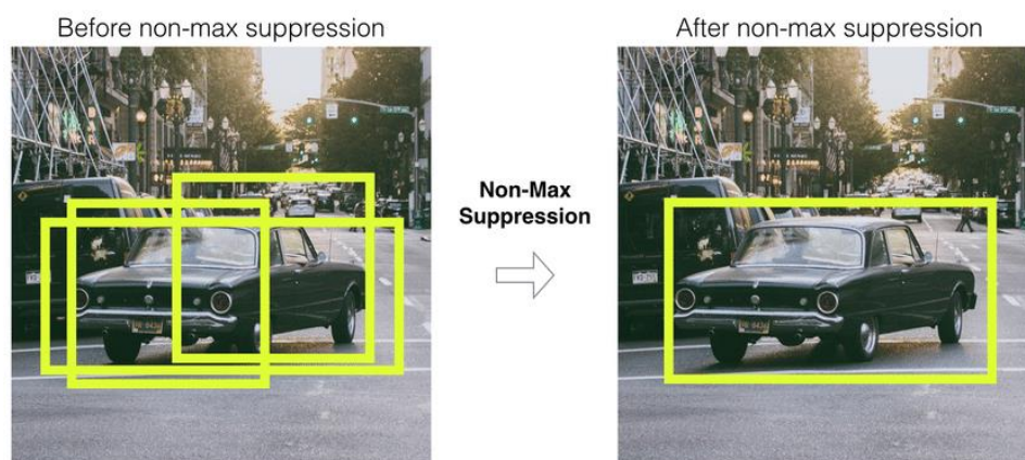
Εικόνα 10: Παράδειγμα μεθόδου Non-Maximum Suppression (Πηγή: https://www.researchgate.net/figure/Non-Maximal-Suppression_fig5_345061606 )
