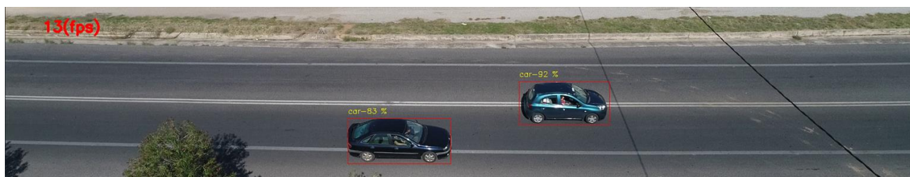
Εικόνα 27: Εφαρμογή αλγορίθμου YOLO με ανάλυση εικόνας 416x416
