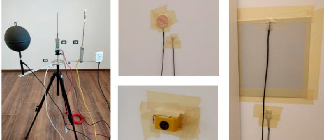
Εικόνα 16 Αισθητήρες για εσωτερικές συνθήκες (αριστερά θερμικής άνεσης , στο κέντρο και δεξιά ροής θερμότητας)
