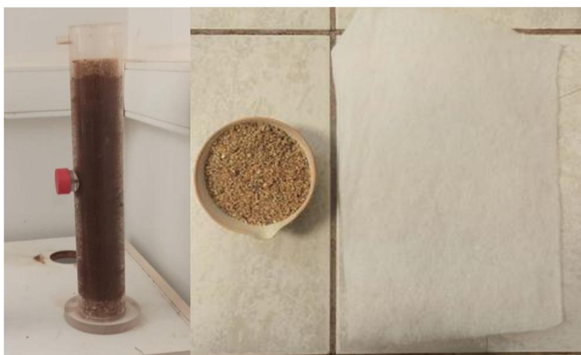
Εικόνα 30. Απεικόνιση διάταξης της στήλης (αριστερά) και χαλαζιακής άμμου με υαλοβάμβακα (δεξιά).
