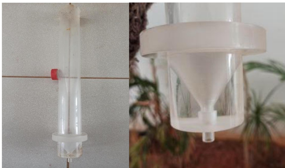
Εικόνα 29. Απεικόνιση εργαστηριακών στηλών από plexiglas (αριστερά) και κωνικής βάσης (δεξιά).
