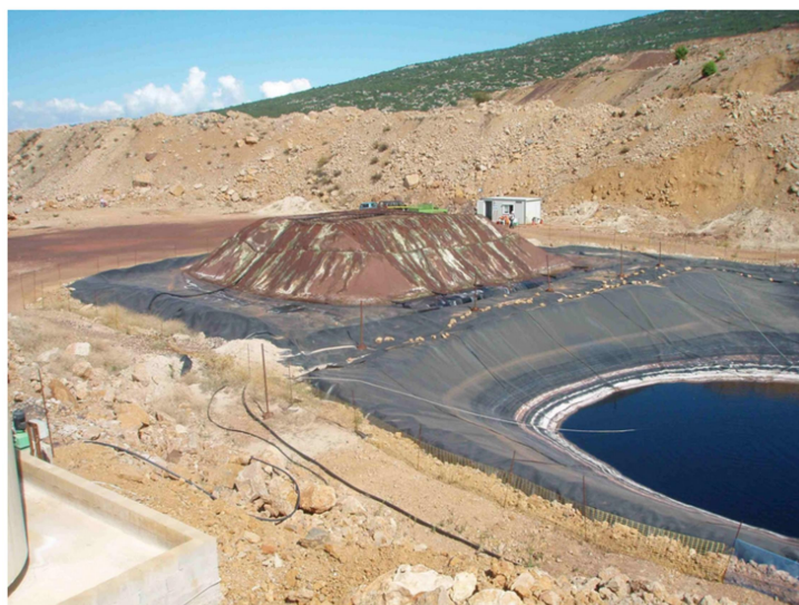
Εικόνα 10. Εκχύλιση λατεριτών σε σωρούς ( www.oryktosploutos.net )
