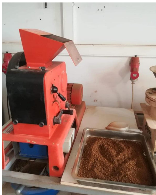
Εικόνα 27. Σιαγωνοτός θραυστήρας και μετάλλευμα Κοπαΐδας.
