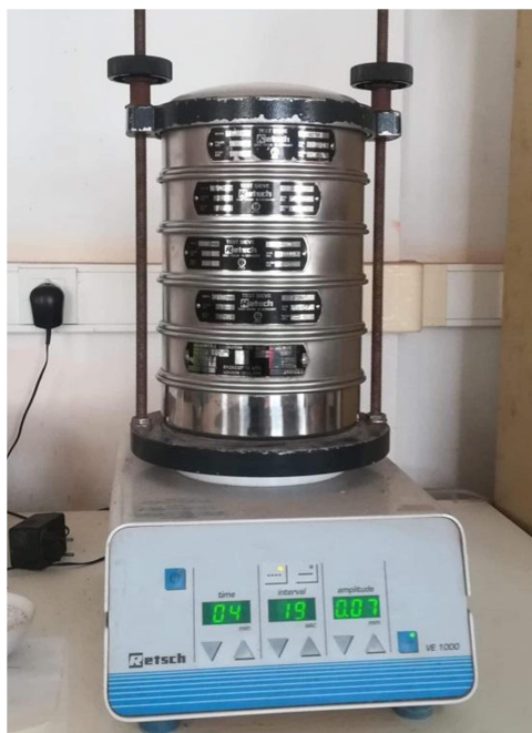
Εικόνα 28. Εργαστηριακή συσκευή ξηρής κοσκίνισης.
