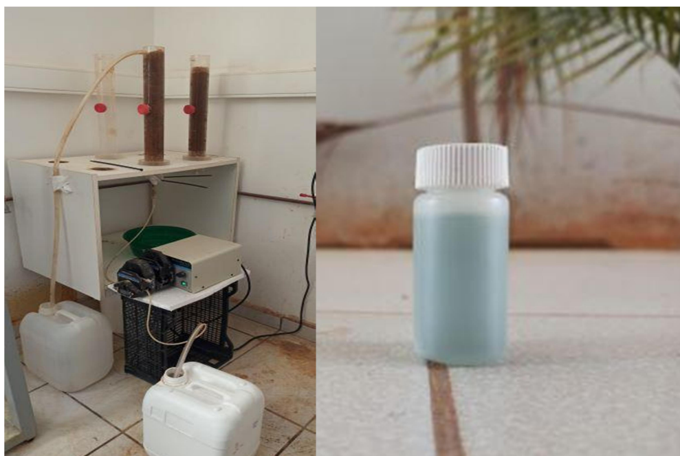
Εικόνα 31. Διάταξη στήλης εκχύλισης (αριστερά) και δείγμα με υγρό εκχύλισης από την έξοδο της στήλης (δεξιά).
