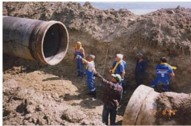
Σχήμα 2.6. (α) Αστοχία μεταλλικού αγωγού και (β) αγωγού μεταφοράς νερού από τον σεισμό του Kocaeli (Nair et al., 2018).
