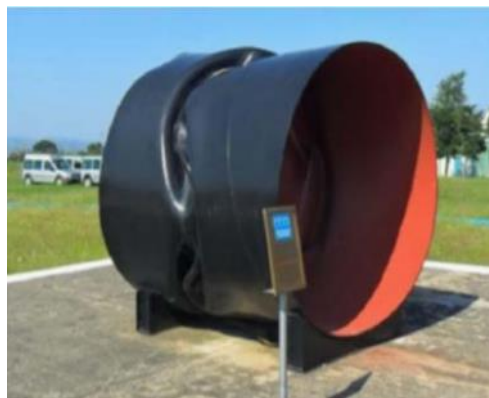
Σχήμα 2.16. Αστοχία αγωγού λόγω τοπικού λυγισμού (Uckan et al., 2015).
