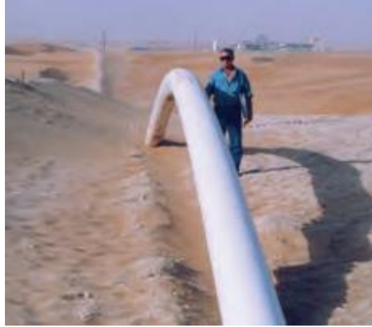
Σχήμα 2.17. Αστοχία αγωγού λόγω καθολικού λυγισμού (Moris Christopher et al., 2018).
