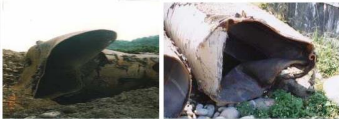
Σχήμα 2.7. Αστοχία μεταλλικών αγωγών από τον σεισμό Chi-Chi (Vazinram & Rasti, 2006).
