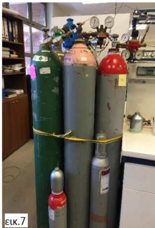
Εικόνα 4.6: εικ.7) φιάλες αερίων τροφοδοσίας, εικ.8) βαλβίδες και ροόμετρα μάζας συνδεδεμένα με τις φιάλες των αερίων και εικ.9) βαλβίδες και ροόμετρα μάζας συνδεδεμένα με τον αντιδραστήρα και το χρωματογράφο.
