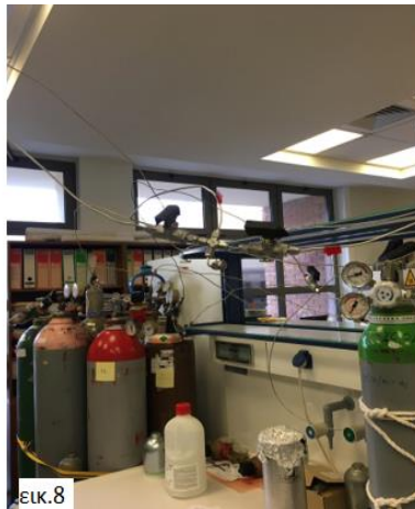
Εικόνα 4.6: εικ.7) φιάλες αερίων τροφοδοσίας, εικ.8) βαλβίδες και ροόμετρα μάζας συνδεδεμένα με τις φιάλες των αερίων και εικ.9) βαλβίδες και ροόμετρα μάζας συνδεδεμένα με τον αντιδραστήρα και το χρωματογράφο.
