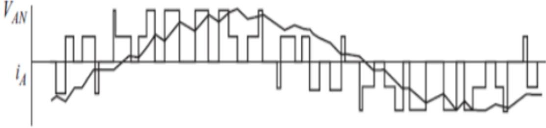
Εικόνα 4.10 Έξοδος Α φάσης τριφασικού αντιστροφέα με τροφοδότηση PWM.
