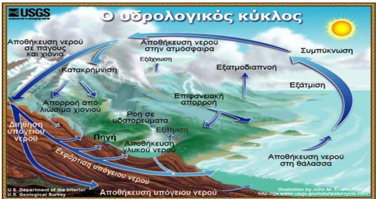
Εικόνα 2.1: Υδρολογικός κύκλος ( https://www.usgs.gov/media/images/water-cycle-greek )
