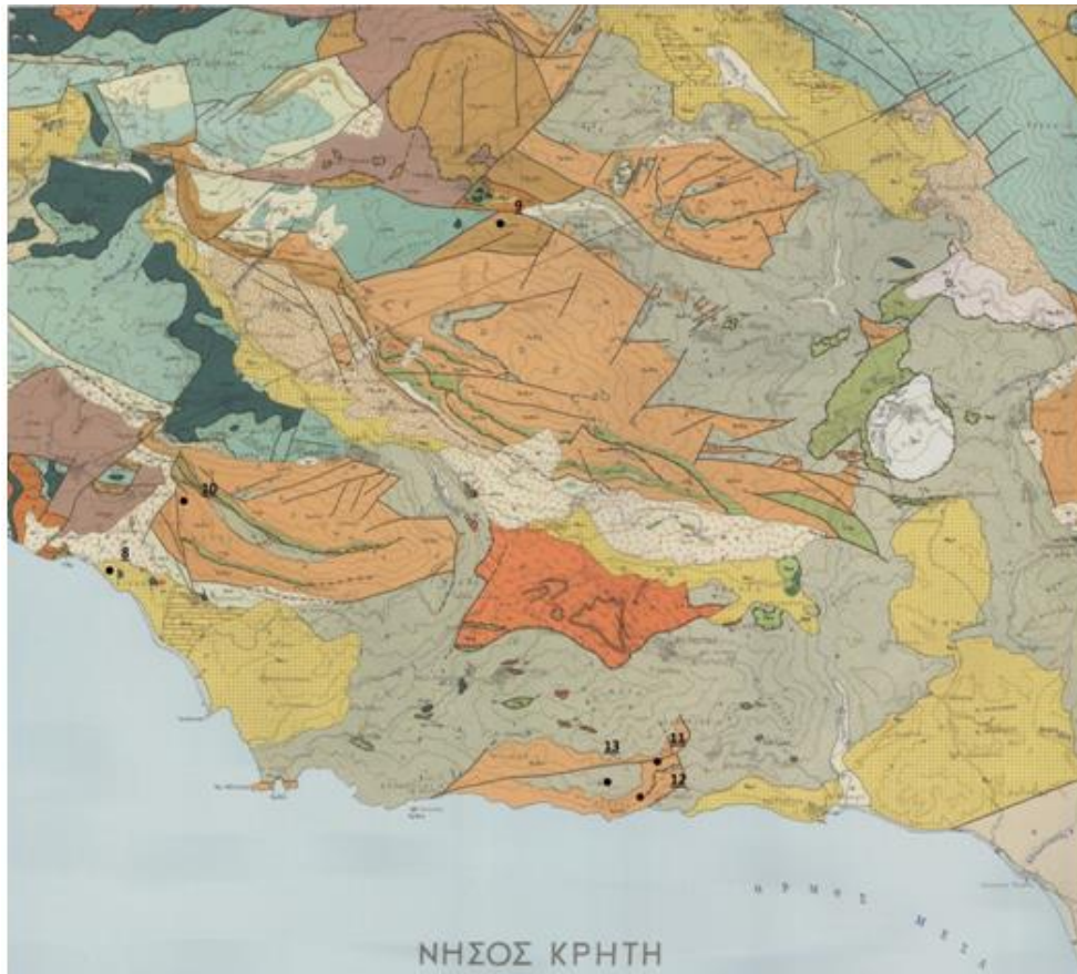
Εικόνα 1-3. Προβολή θέσεων πηγών στο γεωλογικό χάρτη του ΙΓΜΕ Μέλαμπες αρχικής κλίμακας 1:50.000
