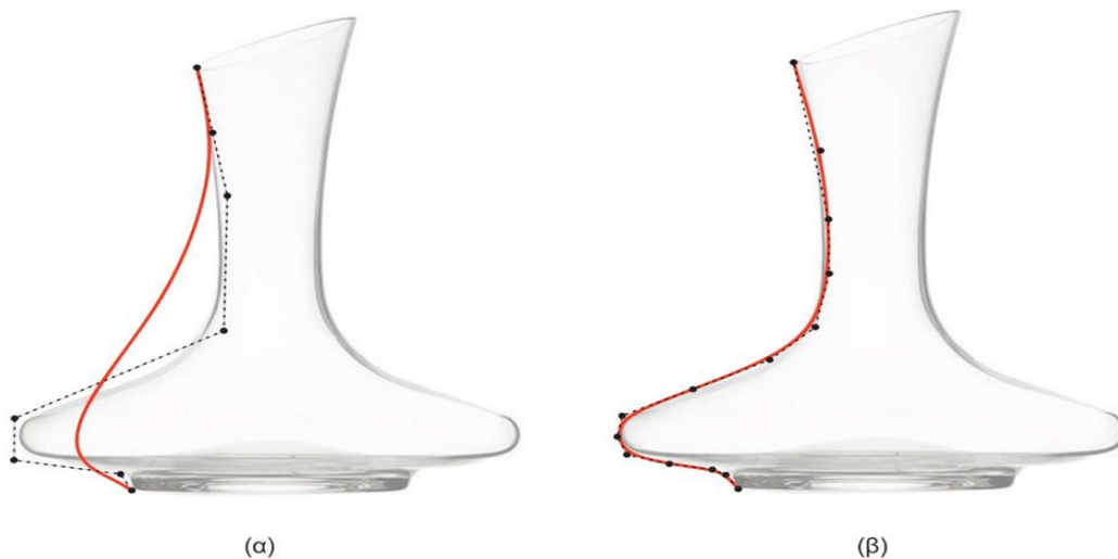
Εικόνα 17: Προσεγγίζοντας ένα σχήμα με Splines. (α) Πρώτη προσέγγιση (Bézier 7ου βαθμού), (β) B-Spline (2ου βαθμού),
