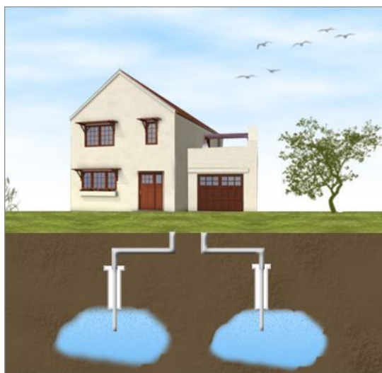
Σχήμα 5.2: Χαρακτηριστική διάταξη γεωθερμικών αντλιών θερμότητας ανοικτού βρόχου
