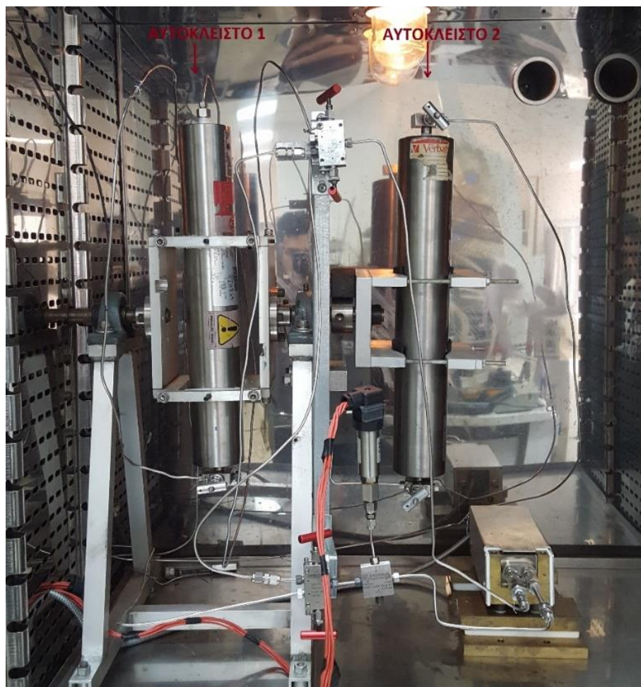
Φωτογραφία 3-4. Τα αυτόκλειστα εντός του θερμοθαλάμου.
