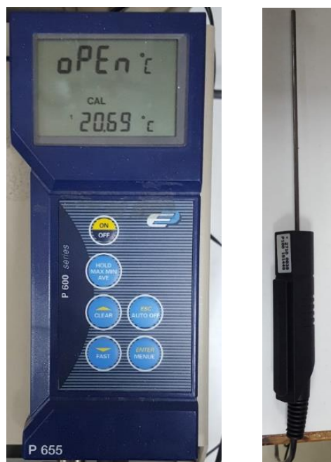
Φωτογραφία 3-2. Θερμόμετρο ακριβείας: οθόνη απεικόνισης (αρ.), αισθητήρας (δεξ.).
