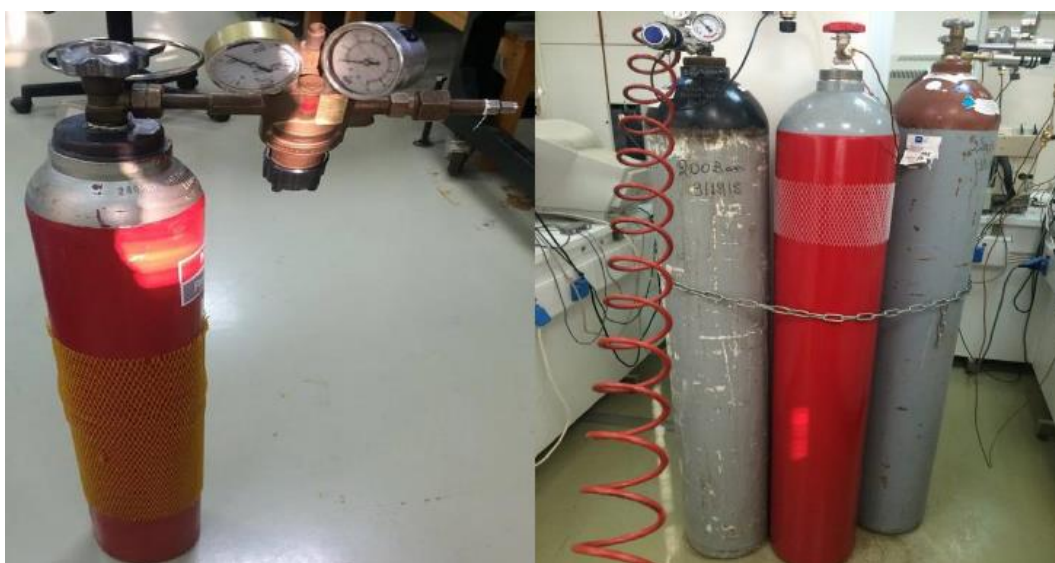
Φωτογραφία 3-10. Φιάλη μεθανίου με το ενσωματωμένο μανοεκτονωτή (αρ.) και φιάλη διοξειδίου του άνθρακα (δεξ. – κόκκινο χρ.).
