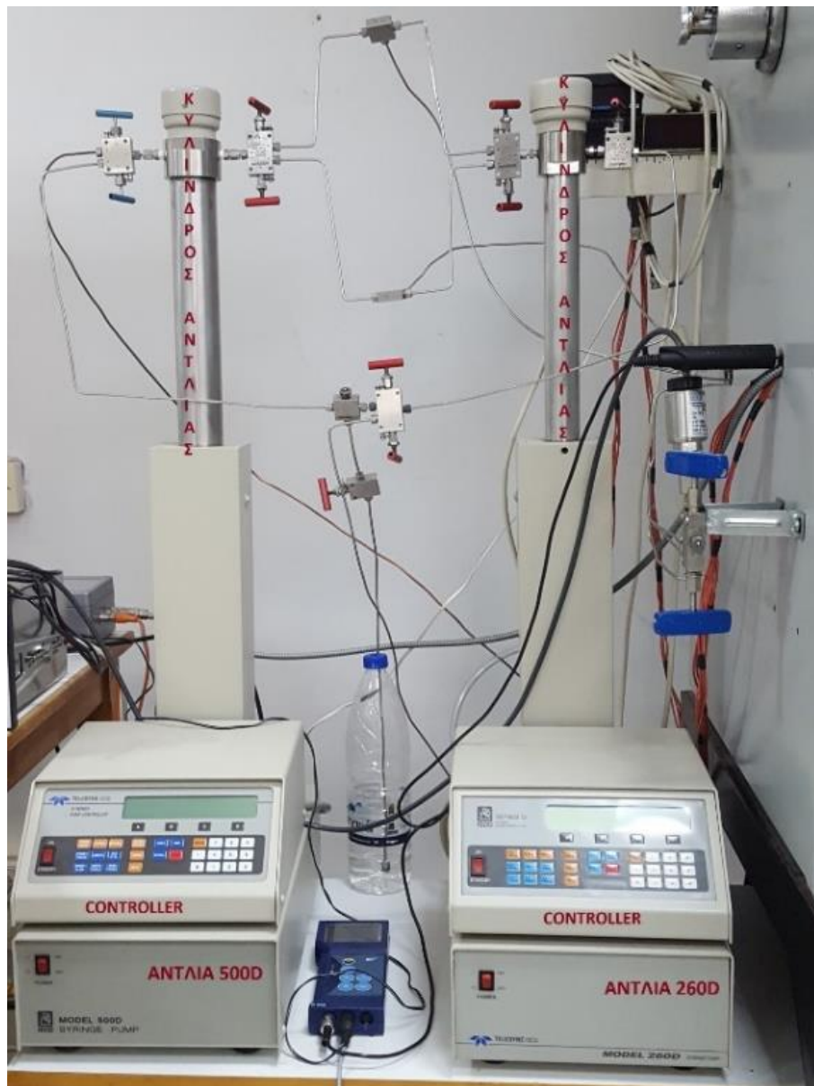
Φωτογραφία 3-3. Οι δύο αντλίες εισπίεσης νερού: Teledyne Isco 500D (αρ.) και Teledyne Isco 260D (δεξ.)
