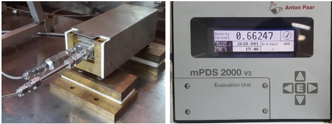
Φωτογραφία 3-6. Εσωτερική μονάδα πυκνόμετρου τοποθετημένη μέσα στο θερμοθάλαμο (αρ.) και Εξωτερική μονάδα συλλογής μετρήσεων (δεξ.).
