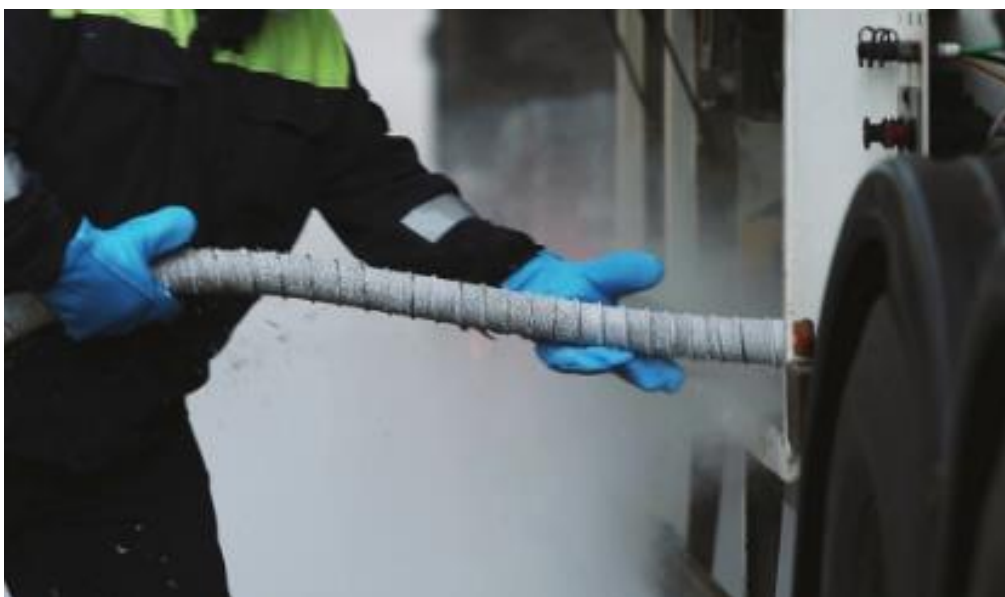
Εικόνα 33, ειδικά γάντια προστασίας από την πολύ χαμηλή θερμοκρασία των σωληνώσεων κατά τον ανεφοδιασμό του πλοίου, πηγή: www.hazchemsafety.com , (05/03/2021)
