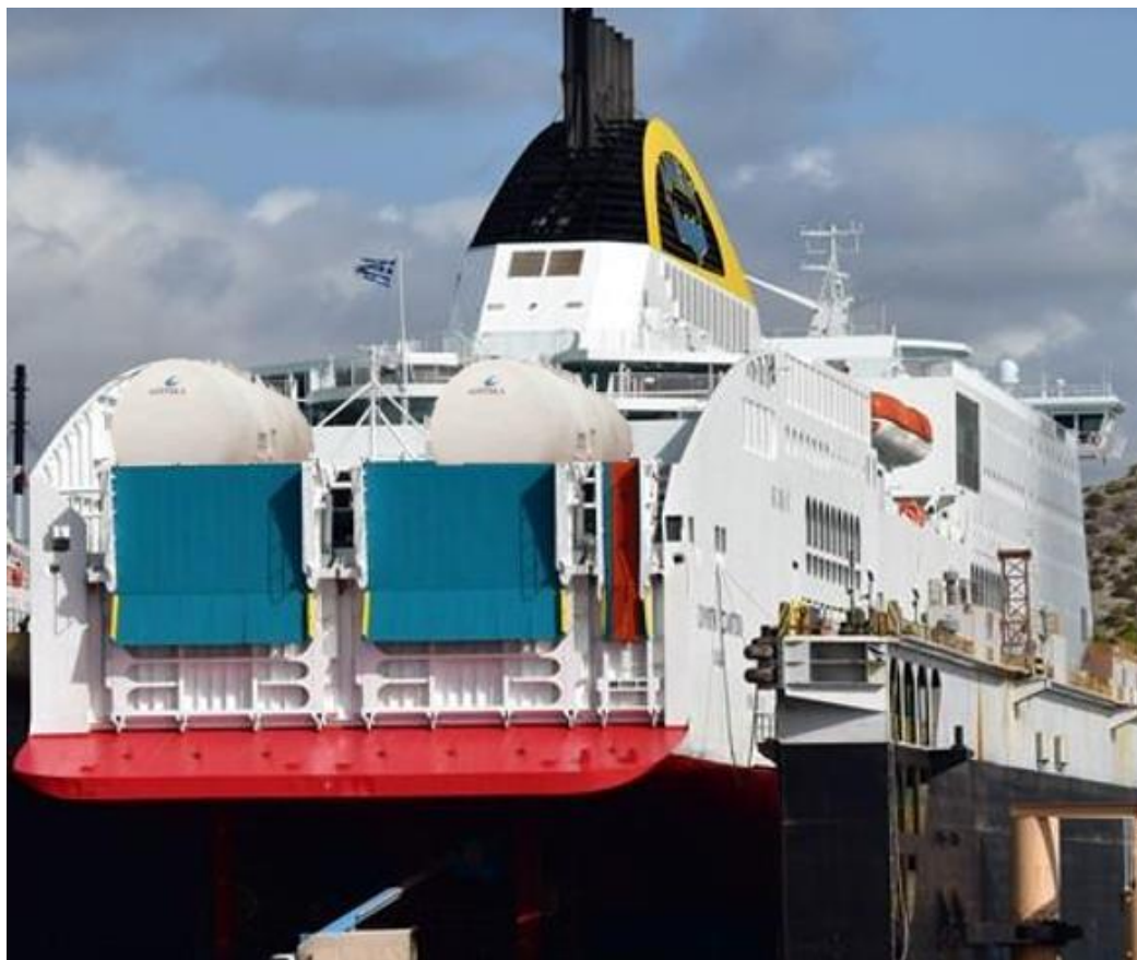
Εικόνα 27, πίσω όψη του πλοίου αν τοποθετηθούν στην πρύμνη οι δεξαμενές του LNG, χωρητικότητας 200m 3
