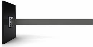
Εικόνα 4.4.3.1 (Μοντέλο μιας δοκού προβόλου)
