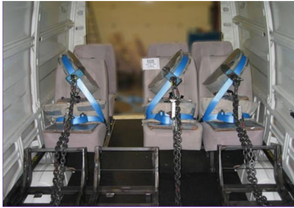
Εικόνα 19. Οι ζώνες ασφαλείας αγκυρωμένες στη συσκευή φόρτισης και αποτελέσματα ανάλυσης του μοντέλου [53]
