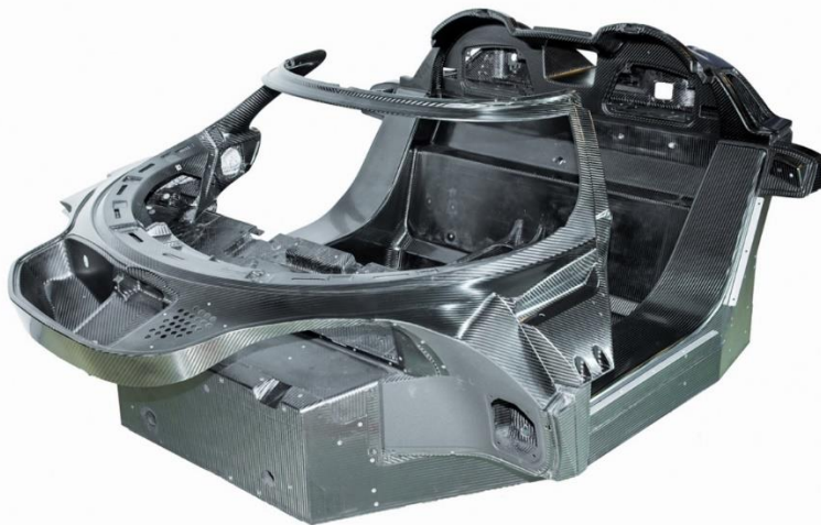
Εικόνα 8. Αυτοφερόμενο σασί από ανθρακονήματα – Koenigsegg Agera Rs
