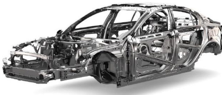
Εικόνα 7. Αλουμινένιο πλαίσιο Jaguar XJ
