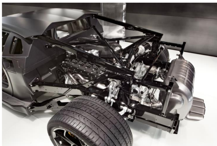
Εικόνα 9. Πίσω υποπλαίσιο κινητήρα. Lamborghini Aventador LP 700-4 του 2015
