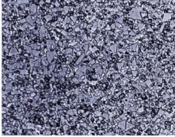
Σχήμα 2.4 Τσιμεντοειδές Καρβίδιο με μεσαίο μέγεθος κόκκων (Πηγή: Sandvik Coromant)
