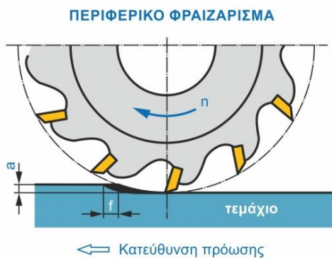
Σχήμα 3.3 Περιφερικό Φραιζάρισμα
