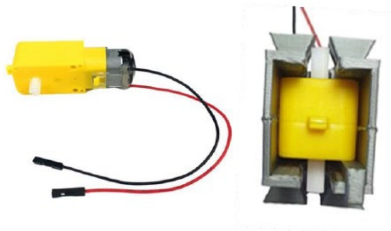
Εικόνα 4.12 Κινητήρας συνεχούς ρεύματος Gear Motor TT-130rpm [26]
