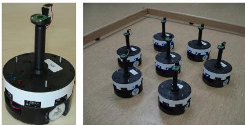
Εικόνα 2: ενός Kibot αριστερά και σμήνους αποτελούμενου από 7 Kibots δεξιά. Τα Kibots είναι σχεδιασμένα από το ερευνητικό κέντρο KOVAN για τη μελέτη της συμπεριφοράς ρομποτικού σμήνους. (Northwestern.edu. (2020). [online])
