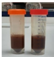
Εικόνα 3.7: Το διαλυμένο μέρος της ΕΙ στο οξύ συλλέγεται σε πλαστικό φιαλίδιο
