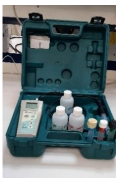
Εικόνα 3.11: Φορητό πεχάμετρο με δυνατότητα ηλεκτρονικής ένδειξης του pH και της θερμοκρασίας, Εργαστήριο Διαχείρισης Τοξικών και Επικίνδυνων Αποβλήτων
