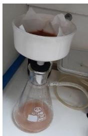
Εικόνα 3.10: Διήθηση υπό κενό σε κωνικό ηθμό με σκοπό την έκπλυση της επεξεργασμένης ΕΙ
