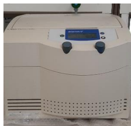
Εικόνα 3.8: Μηχάνημα φυγοκέντρισης με ειδικούς υποδοχείς για κυλινδρικά φιαλίδια, Εργαστήριο Διαχείρισης Τοξικών και Επικίνδυνων Αποβλήτων
