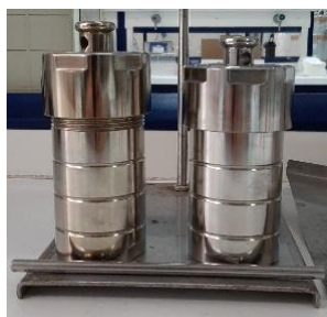
Εικόνα 3.6: Ζεύγος υδροθερμικών αντιδραστήρων κατά τη διάρκεια αργής ψύξης, Εργαστήριο Διαχείρισης Τοξικών και Επικίνδυνων Αποβλήτων
