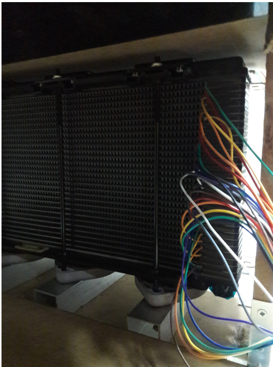
Σχήμα 4.17: Καλωδίωση μεταφοράς της τάσης του κάθε κελιού, από την κυψέλη καυσίμου στην πλακέτα μέτρησης και απεικόνισης των τάσεων.
