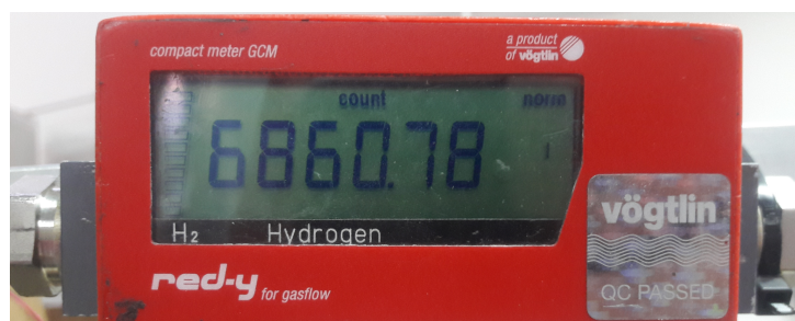
Σχήμα 4.8: Όργανο μέτρησης ροής υδρογόνου και καταγραφής συνολικής κατανάλωσης.
