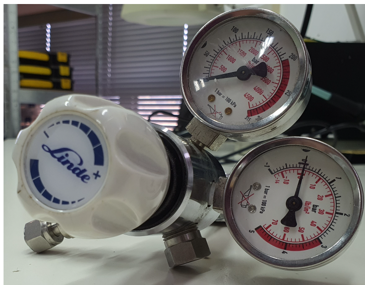
Σχήμα 4.5: Ρυθμιστής πίεσης υδρογόνου.
