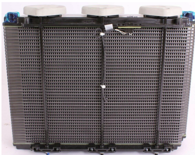
Σχήμα 4.2: Στοιίβα κυψέλης καυσίμου με την οποία εξοπλίζεται το ηλεκτρικό όχημα (FC-GEN 1020ACS).
