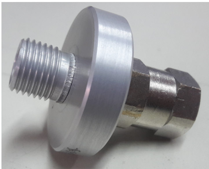
Σχήμα 4.7: Παθητικός ρυθμιστής σταθερής πίεσης στην είσοδο της κυψέλης καυσίμου.
