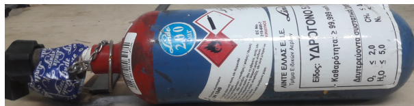
Σχήμα 4.4: Φιάλη ενός λίτρου για χρήση στο ηλεκτρικό όχημα.
