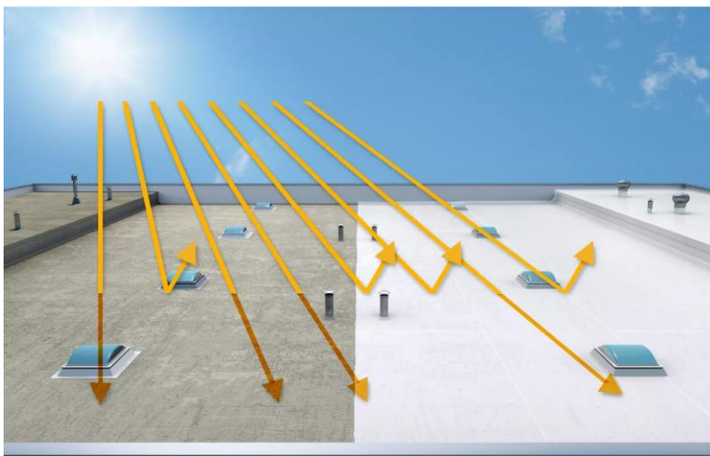
Εικόνα 1.2 Ανακλώμενη και ροή ενέργειας σε επίπεδη οροφή με και χωρίς χρήση ψυχρού υλικού [ΠΗΓΗ: Sika Corporation, 2021]
